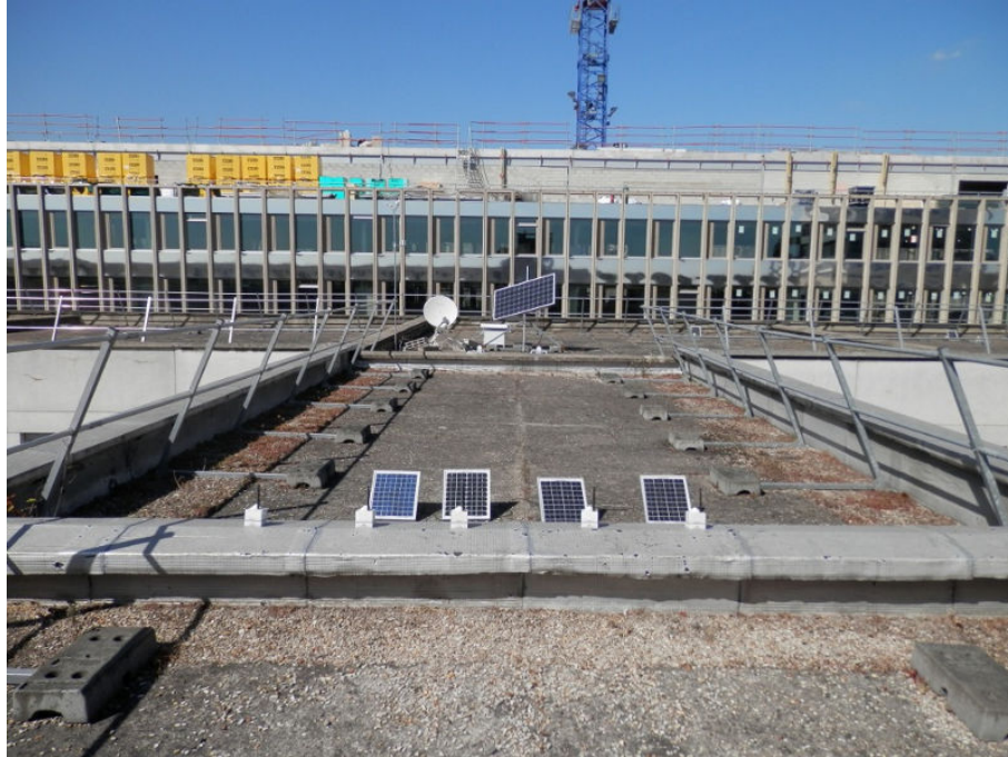
FIGURE 2.14 – Vue partielle (coordinateur et certains récepteurs) du réseau de Geocubes déployé pour tester le module temps-réel.
