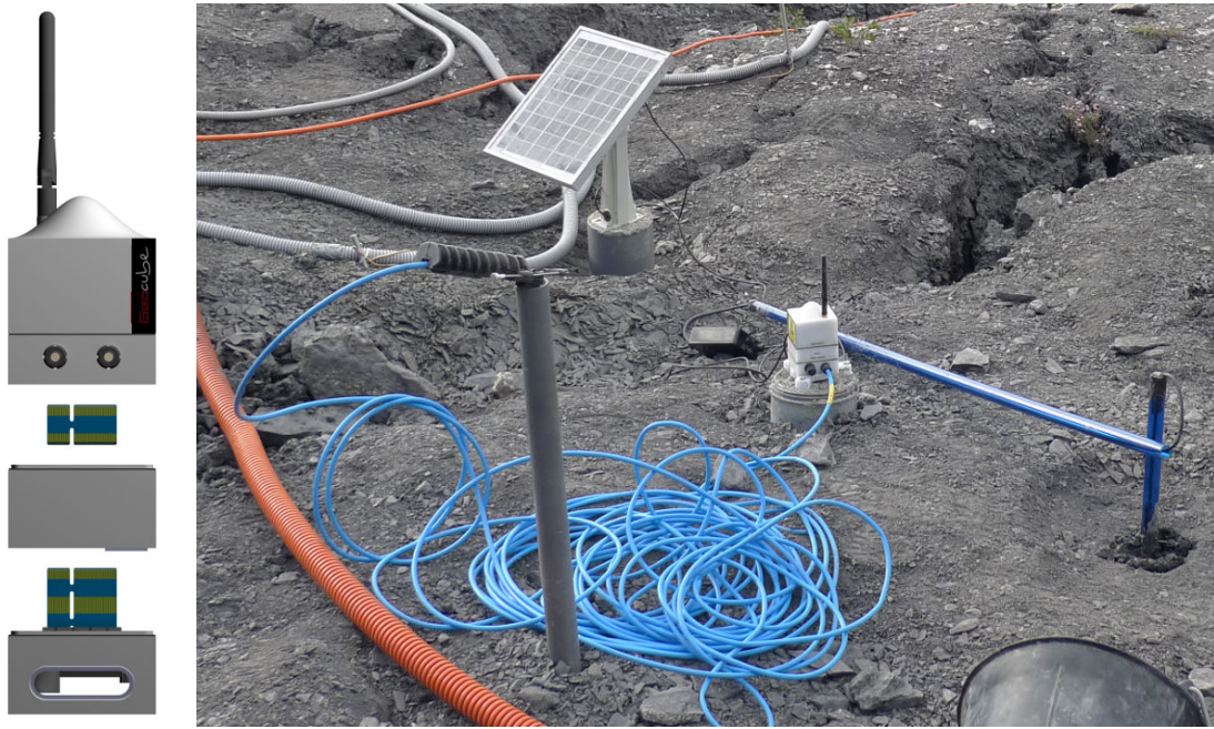
FIGURE 1.10 – Connexion des couches capteurs au boîtier du Geocube. Gauche : connexion carte à carte, droite : connecteur en façade (illustration et photo : O.Martin).
