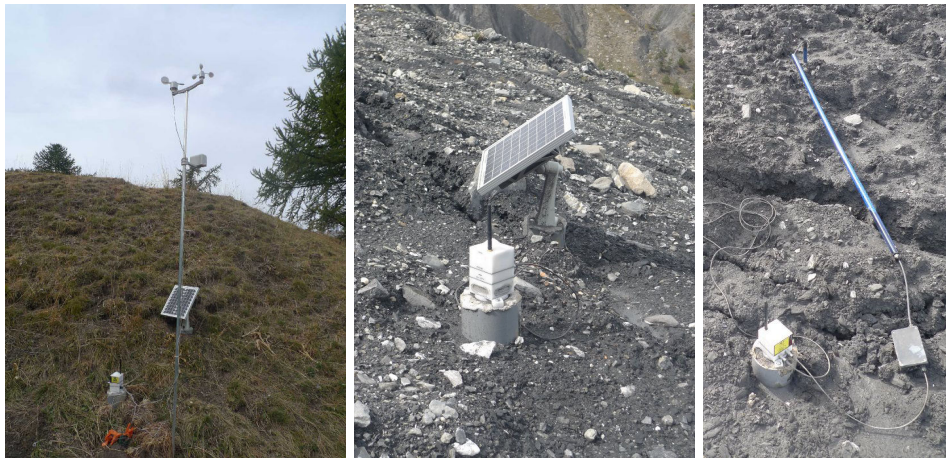
FIGURE 3.4 – Couches capteurs déployées à Super-Sauze. De gauche à droite : station météo, capteur P-T-U, sonde d'étude du sol (photos : O.Martin).
