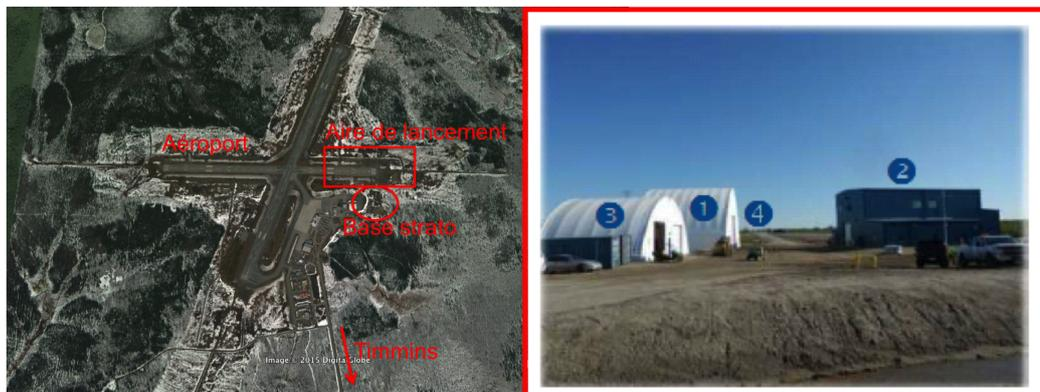
FIGURE 4.5 – La base stratosphérique de Timmins. 1 : hall d'assemblage/entrepôt charge utile. 2 : hall télécommunication/bureaux/salle d'opérations. 3 : entrepôt des moyens de lancements. 4 : accès à l'aire de lancement
