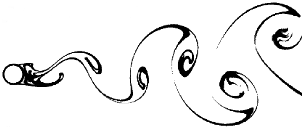
FIGURE 6 – Instabilité de Hopf de l’écoulement autour d’un cylindre fixe. D’après un cliché Sadatoshi Taneda (Université de Kyushu) extrait de [Van Dyke, 1982]
