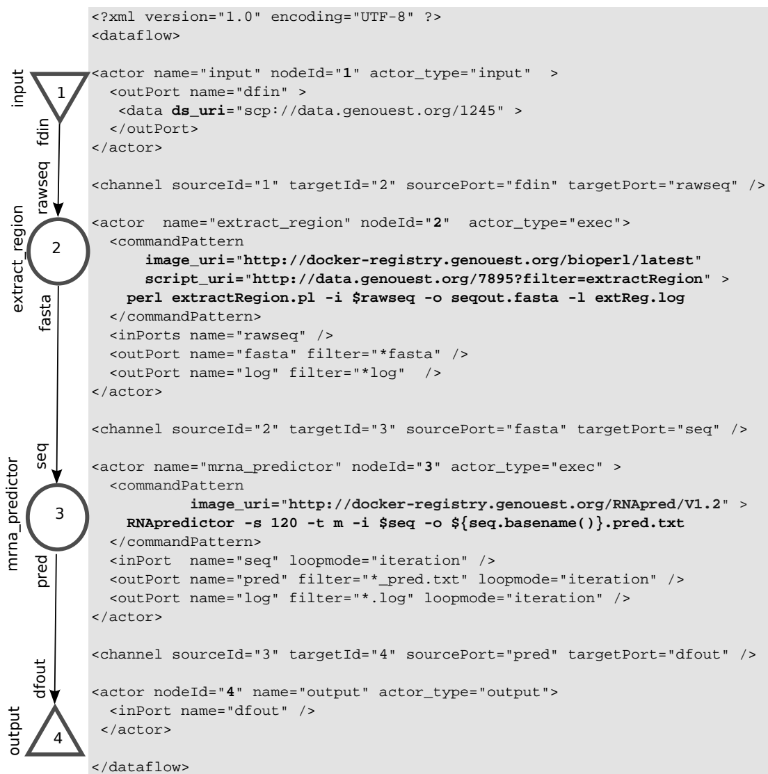
FIGURE 3.16: Spécification DataFlow Autonome: Représentation XML d'un workflow A-SCDFM (Autonomous Semi-Concrete DataFlow Model) correspondant à une spécification autonome. L'ajout d'URI de jeux de données permet de relier la spécification du workflow aux codes des scripts (attribut script_uri ) déployables et à des jeux de données d'entrée (attribut ds_uri ). Les URI d'image de containers (attribut image_uri ) permettent de rapatrier les dépendances des acteurs d'exécution sur les nœuds de calcul. L'ensemble des informations contenues dans cette spécification est suffisant pour permettre l'exécution du workflow sur une infrastructure de type CaaS quelconque.
