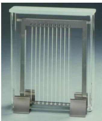
Figure 101 Photo de chromarods utilisés pour les analyses par TLC-FID (d'après [http://www.ses-analysesysteme.de/Zubehoer\\_UK.htm](http://www.ses-analysesysteme.de/Zubehoer_UK.htm)).
