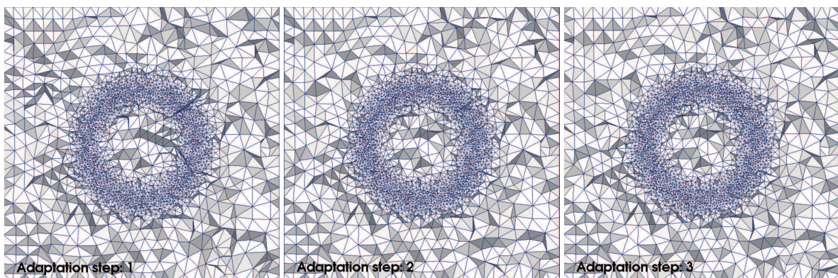
FIGURE 4.35: Exemple d'adaptation en parallèle d'un maillage en parallèle : étapes d'adaptation de 1 à 3 (de gauche à droite).
