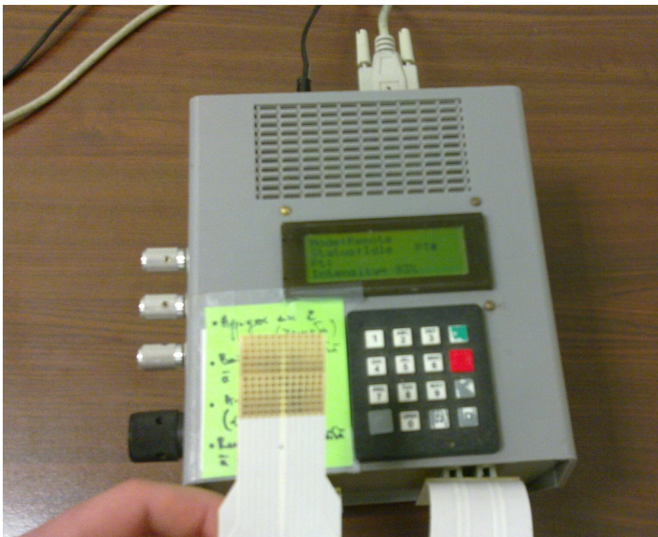
Figure 1. L'unité d'affichage sur la langue TDU (Tongue Display Unit. Version utilisée au cours de notre étude.
