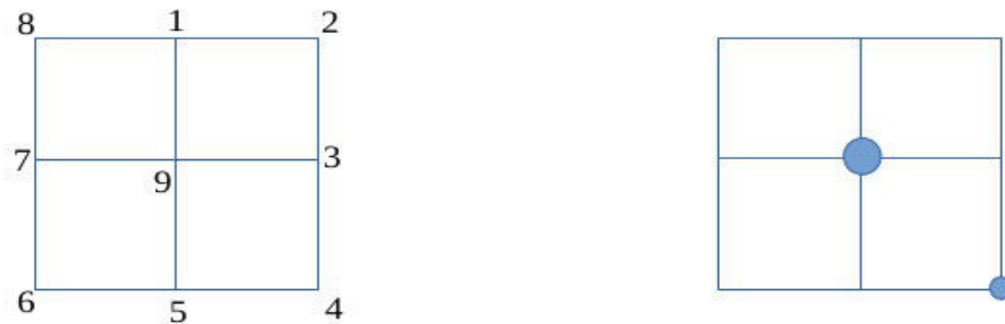
Figure 2.11. Système de codage des chiffres conçu par Saunderson. À gauche, les différentes positions que peuvent prendre les épingles pour désigner un chiffre. À droite, un exemple de code avec le numéro 4.
