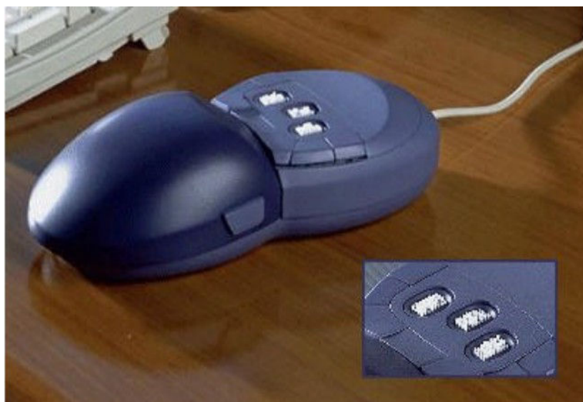
Figure 2.16. VirTouch Mouse (VTM) : une souris tactile qui intègre les fonctions d'affichage tactile à l'utilisateur ainsi que les fonctions d'une souris normale
