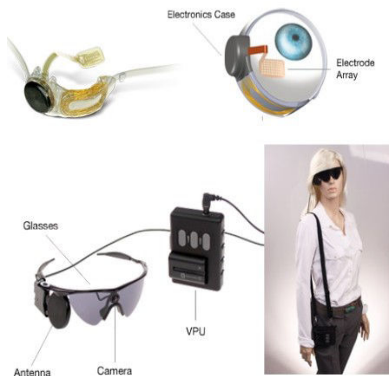
Figure 1.14. : Le système ARGUS II comporte un implant rétinien, une caméra pour l'acquisition des images et une unité de traitement qui transforme l'information et gère la stimulation ( 2-sight.eu/en/system-overview-en )
