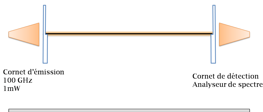
FIGURE 5.8 – Evaluation expérimentale des pertes par couplage se fait avec une transmission directe en déduisant l'atténuation le long du fil des pertes totales.
