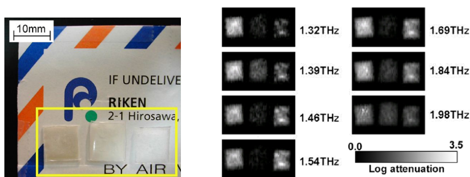
FIGURE 1.5 – Détection de drogue à travers une enveloppe. [Pickwell 06]
