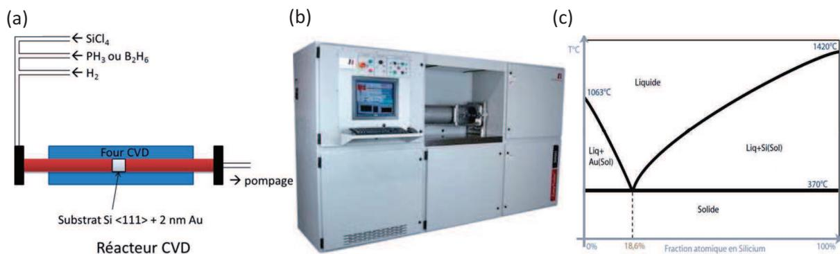
Figure V-1 : (a, b) Réacteur CVD Easy Tube™ 3000 utilisé pour la croissance des nanofils de silicium (a) schéma et (b) photo. (c) Diagramme de phase du système binaire Au-Si.
