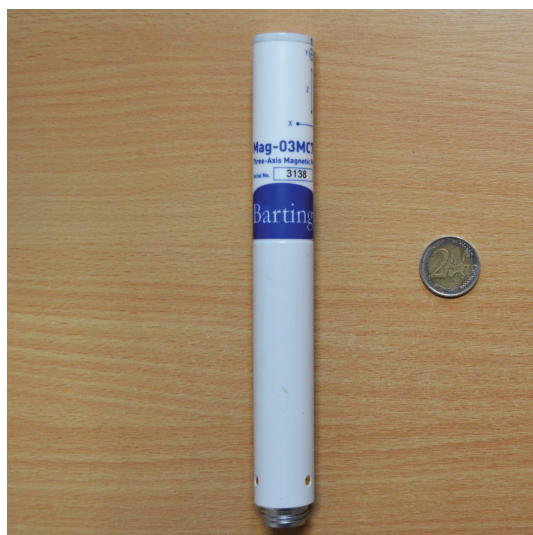
Figure 1.11 – Magnétomètre à vanne de flux. Modèle Mag-03 MC70 de Bartington Instruments (Bruno Gavazzi).
