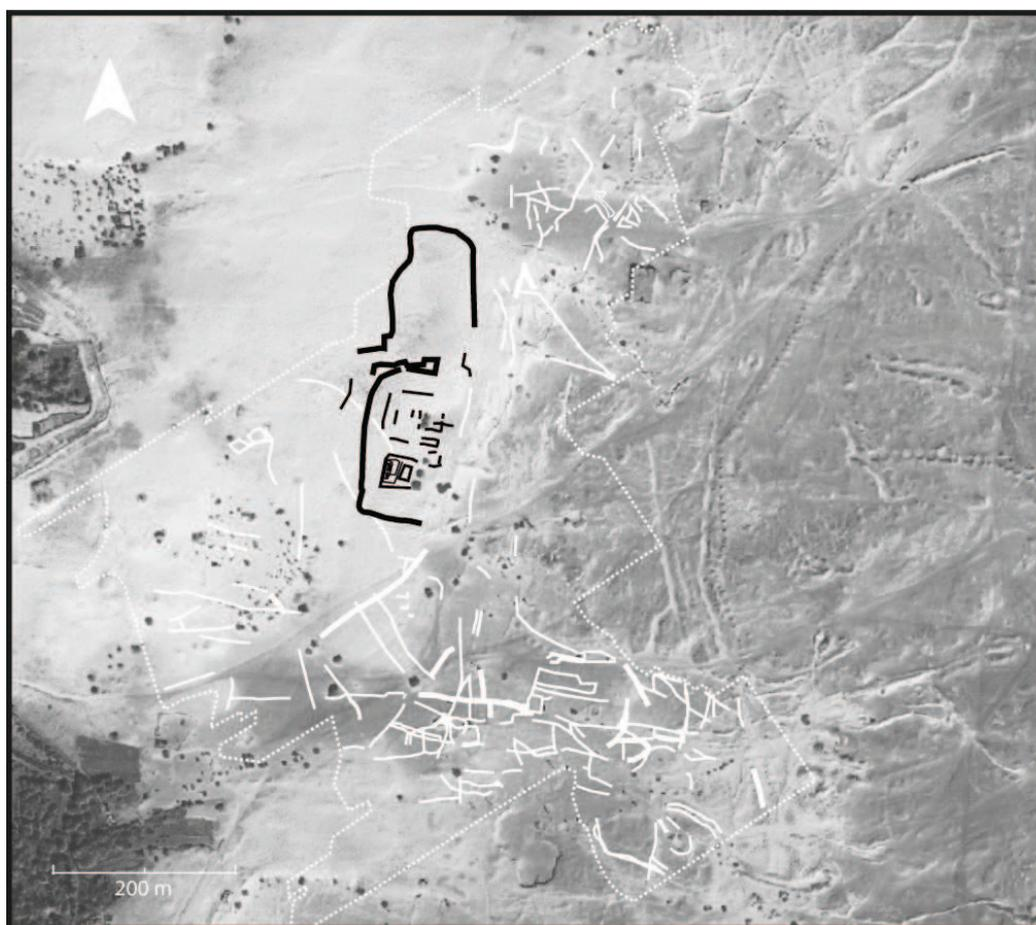
**Figure 5.7** – Carte interprétative des sources des différentes linéations sur une image satellite de 2003 (références voir Figure 1.4, p. 25). Les structures hydrauliques sont représentées en blanc, le bâti en noir.
