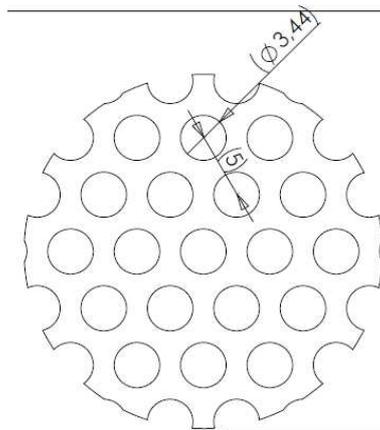
Figure 17 : Grille utilisée pour la génération de turbulence par mono-grille
