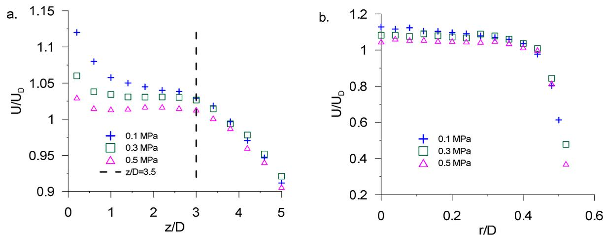
Figure 42 : Variation de la vitesse moyenne normalisée par la vitesse débitante (a) selon l'axe central du brûleur (mesure fil chaud) (b) selon le rayon du brûleur normalisé par le diamètre à  $x/D = 0,2$
