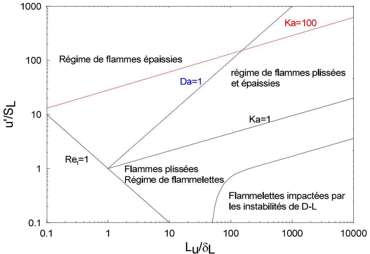
Figure 14 : Diagramme de combustion turbulente [71]
