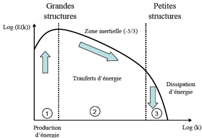
Figure 7 : Représentation schématique du spectre d'énergie cinétique d'une turbulence de grille
