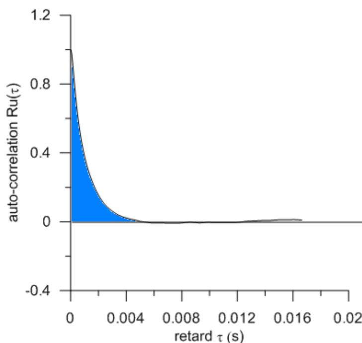
Figure 6 : Courbe d'autocorrélation de la vitesse fluctuante  $u'$
