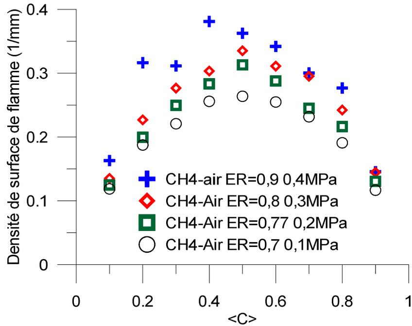
Figure 67 : DSF en fonction des iso<C> pour les cas à  $u'/S_L$  équivalents
