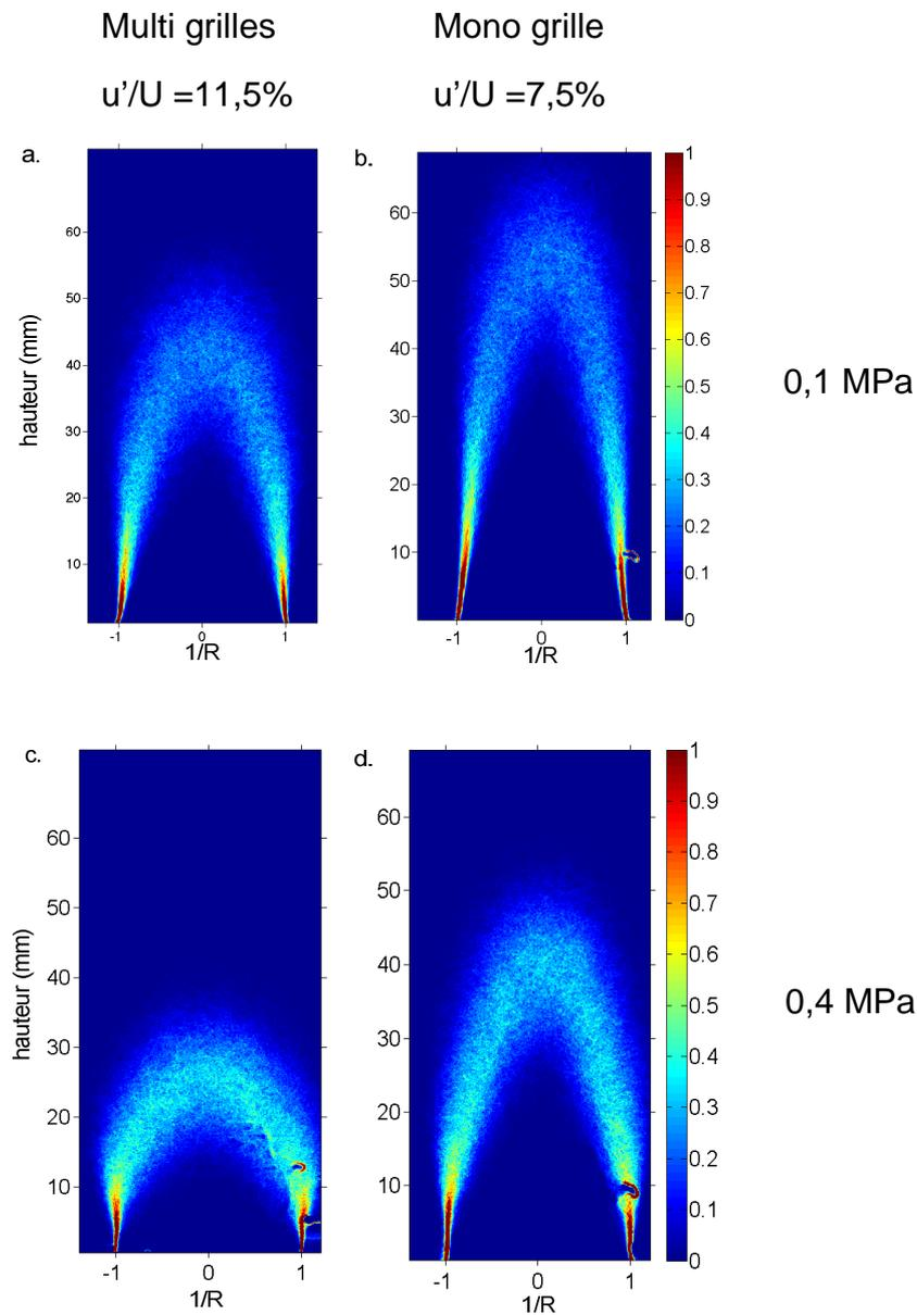
Figure 62 : DSF locales pour les systèmes mono-grille et multi-grilles : (a) CH<sub>4</sub>-air  $\phi=0,85$  0,1 MPa multi-grilles (b) CH<sub>4</sub>-air  $\phi=0,85$  0,1 MPa mono grille (c) CH<sub>4</sub>-air  $\phi=0,9$  0,4 MPa multi-grilles (d) CH<sub>4</sub>-air  $\phi=0,9$  0,4 MPa mono-grille ( $\Sigma$  en  $\text{mm}^{-1}$ )
