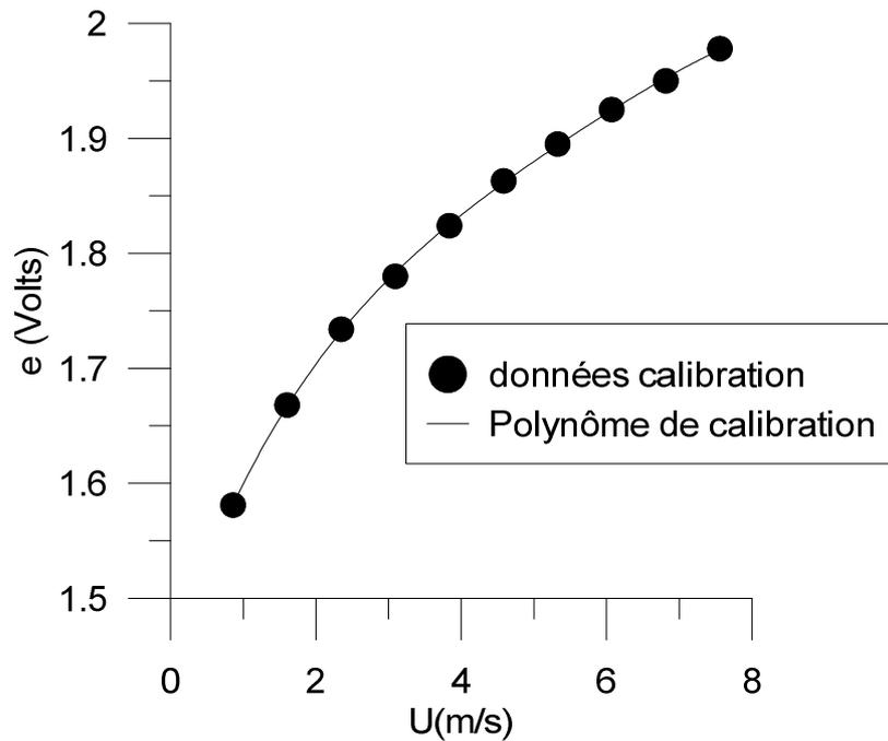
Figure 21 : Courbe de calibration et polynôme associé à pression atmosphérique
