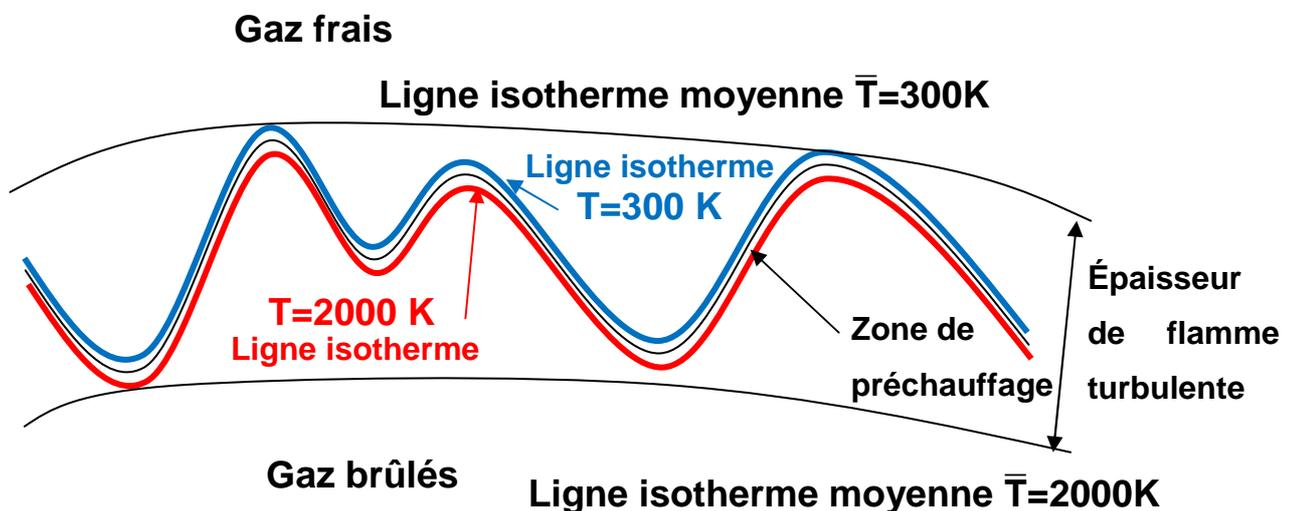
Figure 11 : Schéma d'un front de flamme en régime de flammelettes ou de flammes plissées
