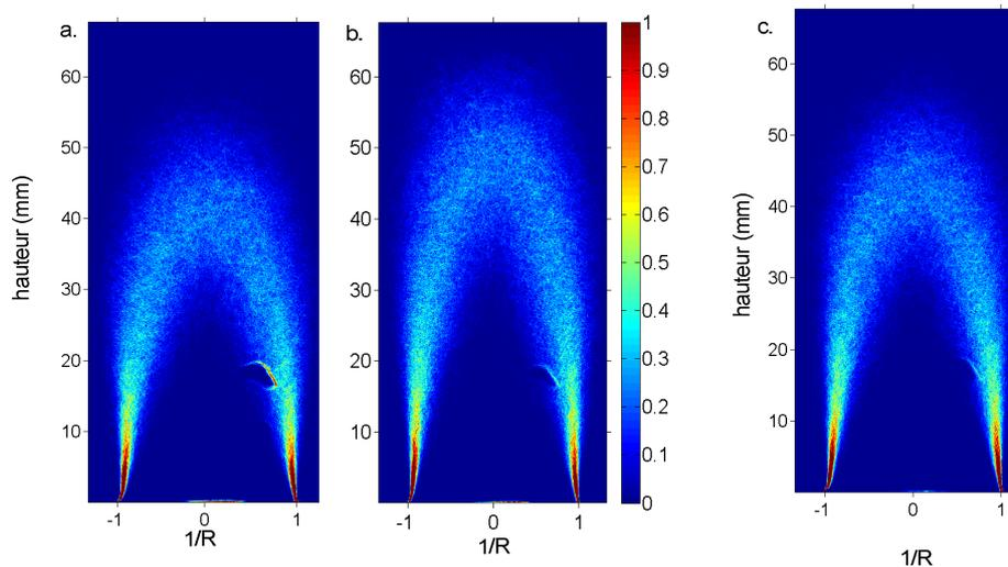
**Figure 58 : Densité de surface de flamme à pression atmosphérique (a)  $\phi=0,7$  80% CH<sub>4</sub> - 20% H<sub>2</sub> – air (b)  $\phi=0,6$  70% CH<sub>4</sub> - 30% H<sub>2</sub> – air (c)  $\phi=0,8$  CH<sub>4</sub>-air ( $\Sigma$  en mm<sup>-1</sup>)**
