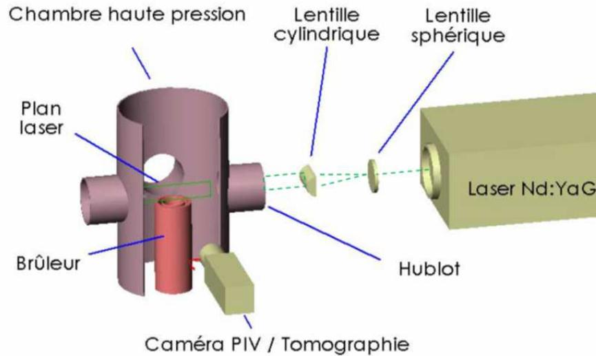
Figure 27 : Schéma de principe de la tomographie laser
