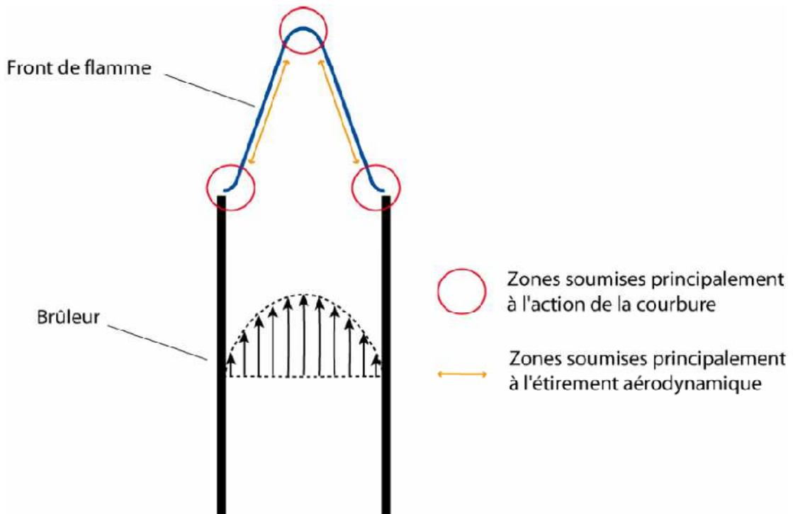
Figure 5 : Schématisation d'une flamme laminaire conique
