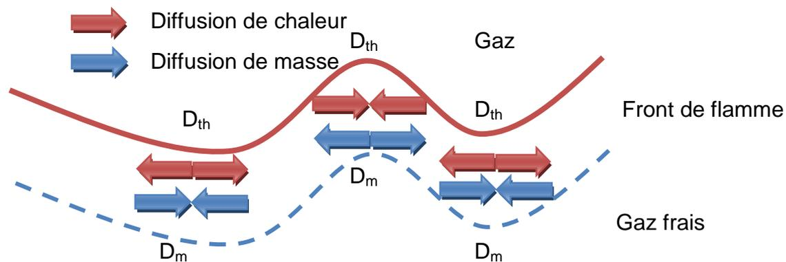
Figure 4 : Schéma explicatif des instabilités thermodiffusives
