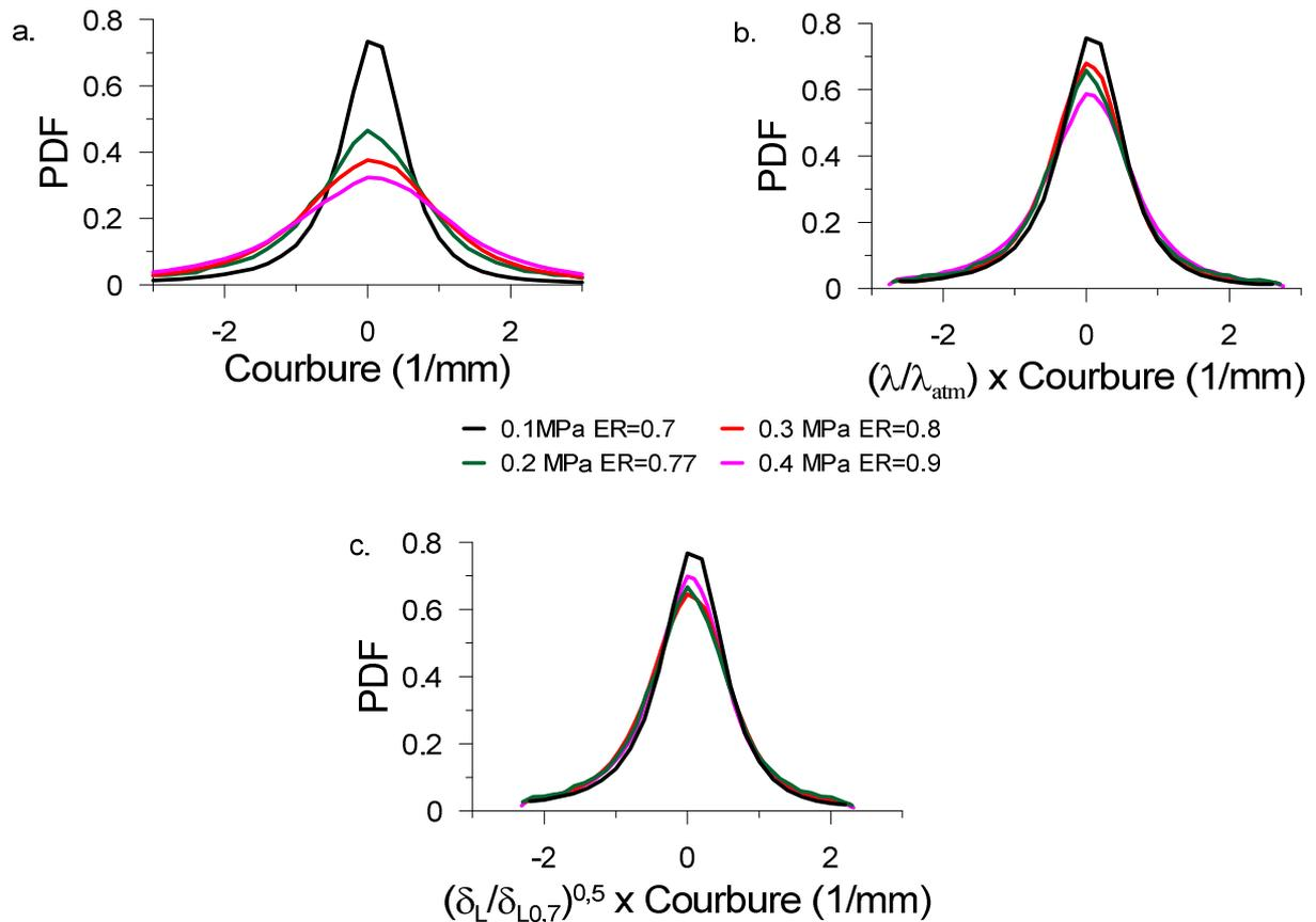
Figure 68 : PDF des courbures de flamme des cas étudiés à  $u'/S_L$  constant : (a) PDF des courbures sans normalisation (b) PDF des courbures normalisée par l'échelle de Taylor (c) PDF des courbures normalisées par l'épaisseur de flamme laminaire
