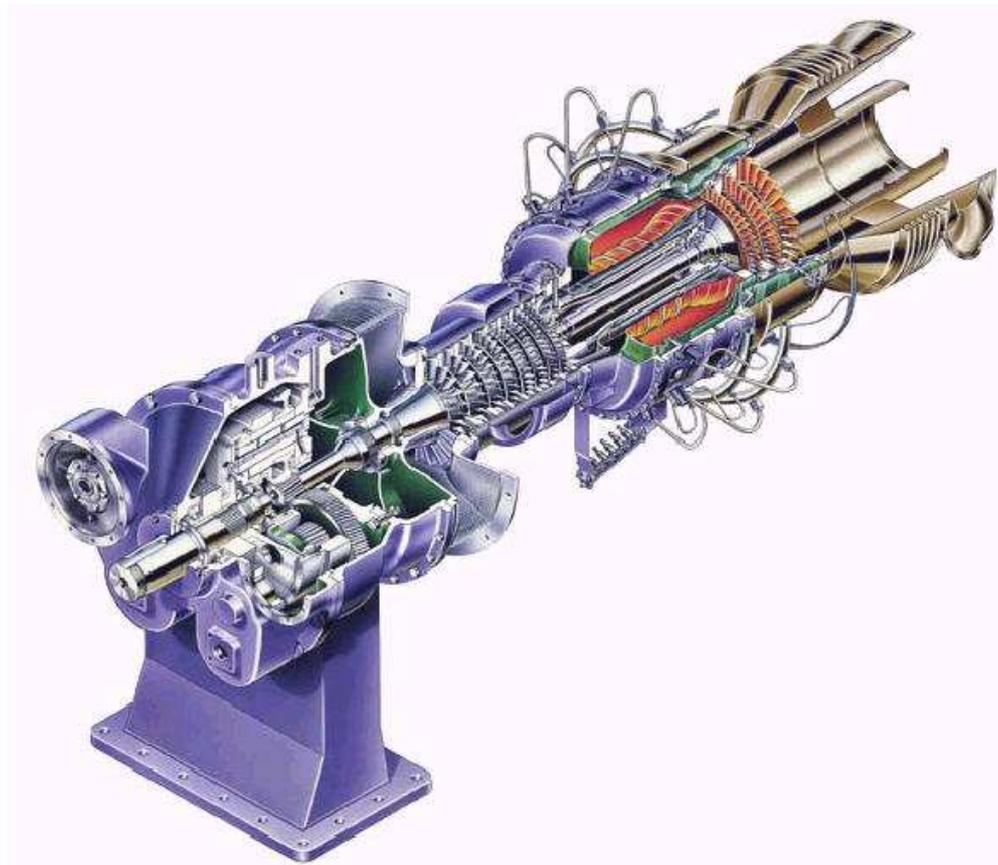
Figure 1 : Turbine à gaz terrestre Solar Turbines
