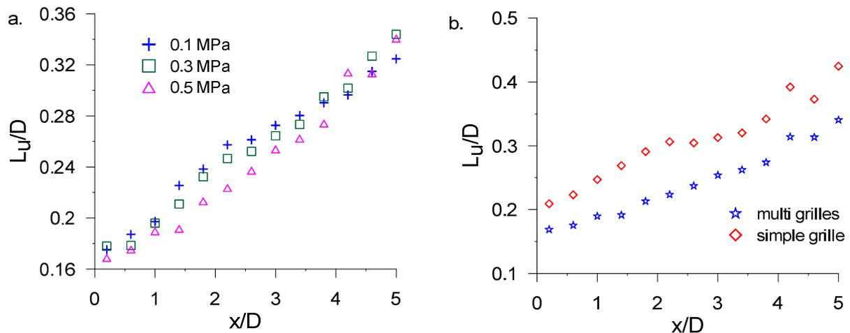
**Figure 49 : Évolution de l'échelle intégrale longitudinale normalisée par le diamètre du brûleur le long de l'axe central du brûleur (a) pour différentes pressions (dispositif multi-grilles) (b) pour différents systèmes de génération de turbulence (0,5 MPa)**
