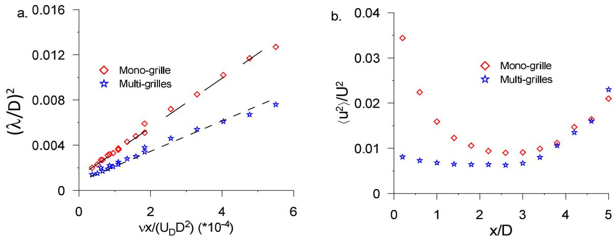
**Figure 54 : (a) Effet de la pression sur l'échelle de Taylor. Les lignes pointillées représentent les meilleures approximations avec l'équation (68). (b) Evolution axiale du tenseur de Reynolds  $\langle u^2 \rangle$  le long de l'axe central du jet à 0,5 MPa**
