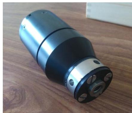
Figure 2.12 - Excitateur piezoshaker Wilcoxon Meggit F7.
