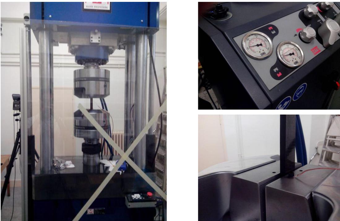
Figure 3.14 - Machine d'essai Maser 550 kN avec détails du serrage d'une éprouvette par un mors.
