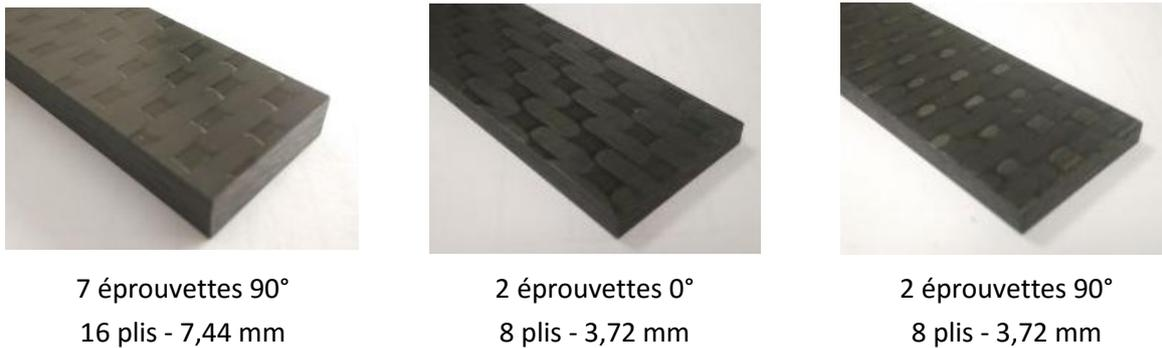
Figure 3.8 - Les trois configurations d'éprouvettes testées
