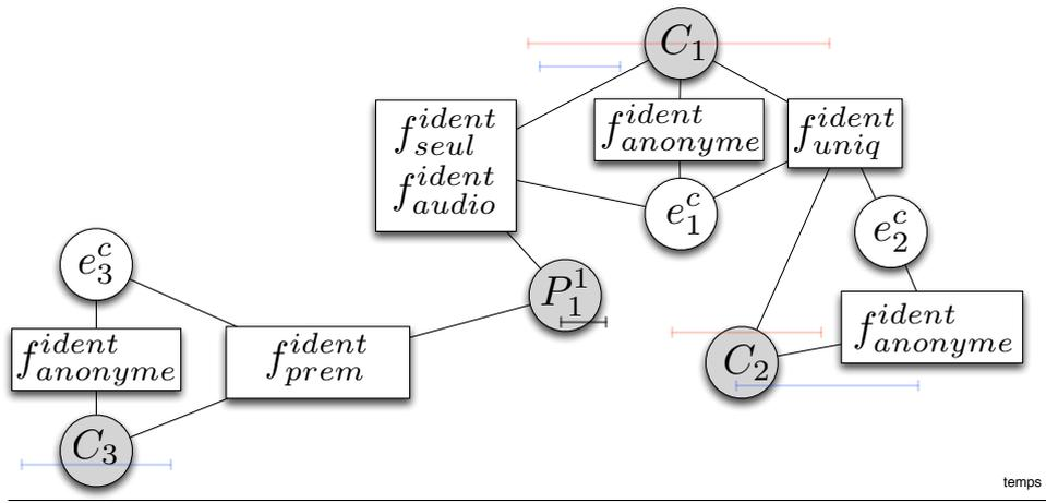
FIG. 6.2: Graphe de facteurs représentant le CRF utilisé pour le nommage. La classe  $C_1$  apparaît avec le cartouche  $P_1^1$ . Les différentes fonctions de nommage sont donc non nulles entre ces variables. Les classes  $C_1$  et  $C_2$  apparaissent en même temps, la contrainte d'unicité s'applique donc entre ces 2 classes.
