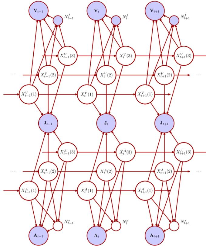
FIG. 2.7: Représentation du modèle utilisé par [Noulas 2012]. Les nœuds bleutés représentent les variables observées, les autres nœuds représentent les variables cachées. Le nœud  $N^s$  est une variable additionnelle servant à modéliser la parole superposée. Les autres nœuds ont été introduits dans le texte. Figure extraite de [Noulas 2012].
