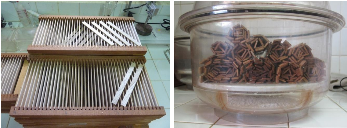
Figure 150 : Conditionnement et stabilisation hygrométrique des échantillons avant la mesure du module. A gauche : dans les raques avant l'étape de séchage en étuve à 103° pendant 72 h ; à droite : conditionnement dans la cloche de stabilisation en sortie d'étuve jusqu'au moment de la mesure.
