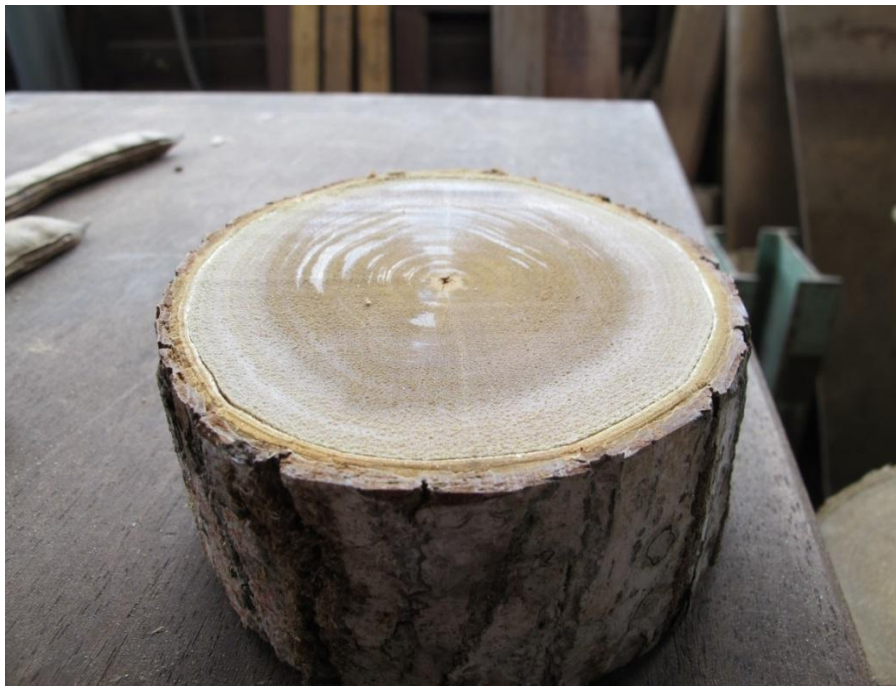
Figure 30 : Observation d'une zone de bois de tension chez un individu de B. guianensis à la lumière rasante. La surface brillante correspond à la zone de bois de tension.
