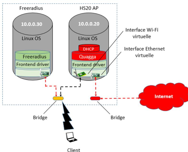
Figure 19 : Architecture Hotspot2.0 virtuel avec client non authentifié
