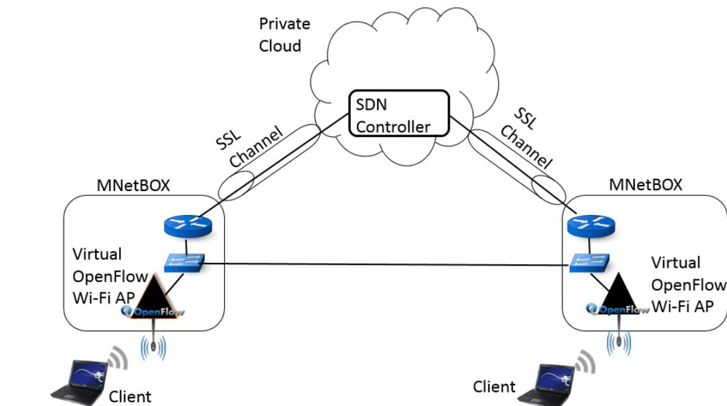
Figure 31 : Architecture des points d'accès Wi-Fi OpenFlow virtuels
