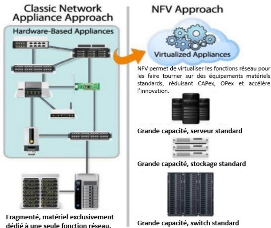
Figure 2: L'approche réseau classique et l'approche NFV
