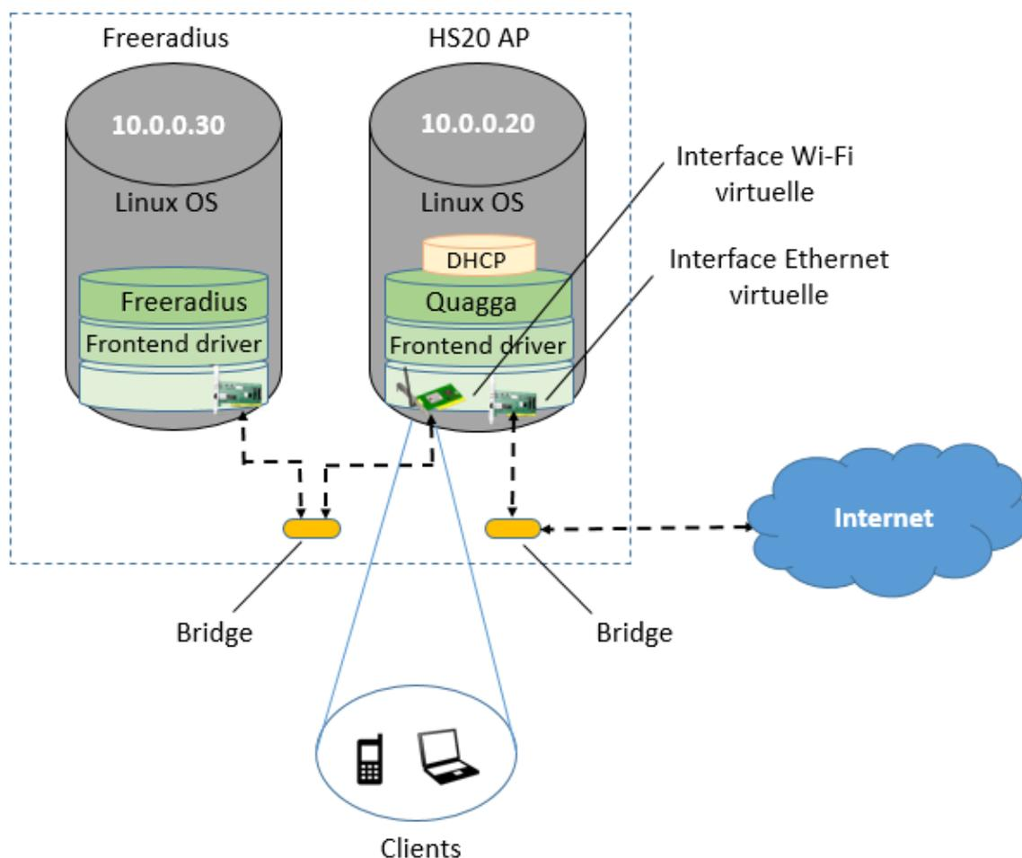
Figure 18 : Architecture de notre point d'accès Wi-Fi Hotspot2.0 virtuel
