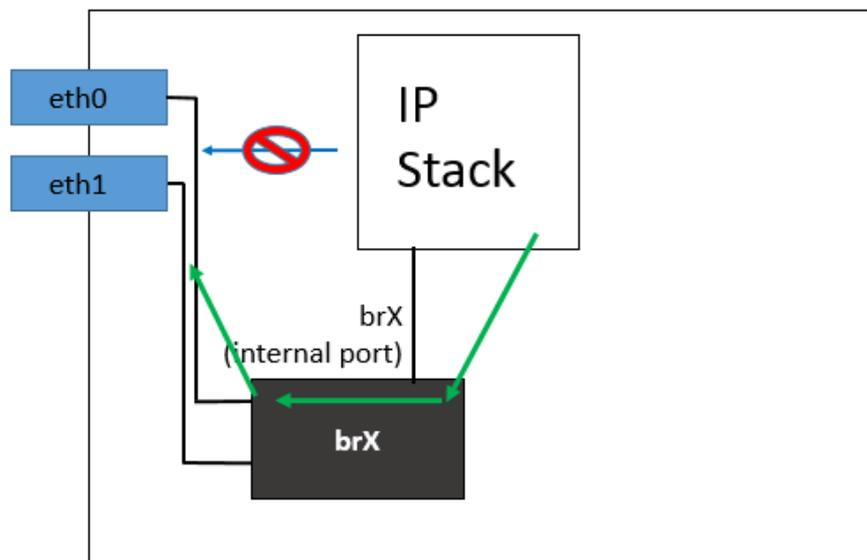
Figure 30 : Interfaces bridgées au bridge OVS
