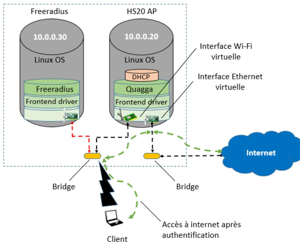
Figure 21 : Architecture Hotspot2.0 virtuel avec client authentifié
