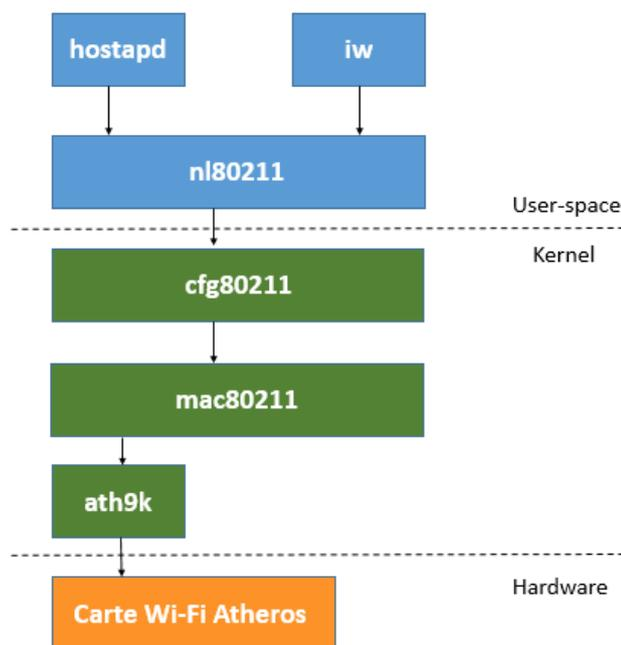
Figure 6: Interaction logicielle entre user-space et kernel
