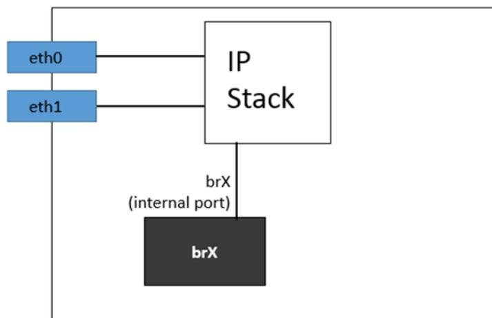
Figure 29 : Création d'un bridge OVS, interfaces non bridgées
