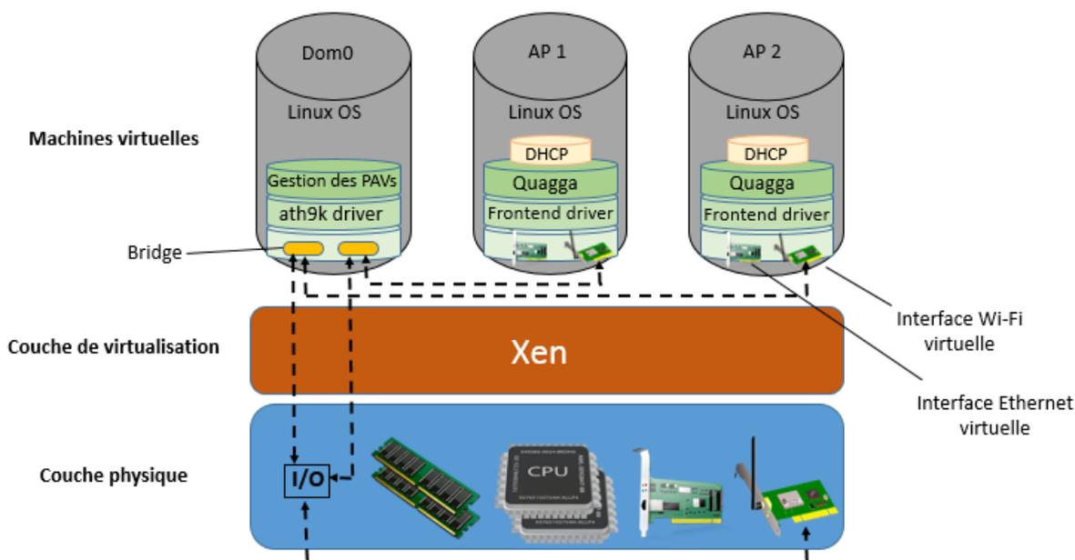
Figure 7: Architecture des points d'accès Wi-Fi virtuels
