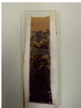
Figure III-77: Décantation du PCBM dans un mélange DDMA:LMA:AIBN au cours d'un traitement thermique en moule fermé de 1mm
