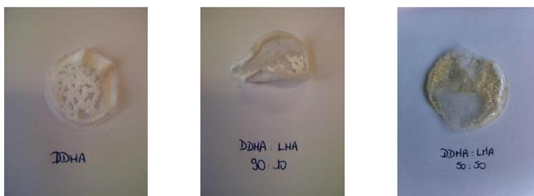
Figure III-66: Films DDMA et DDMA:LMA 90:10 et 50:50 amorcés par 2% massique d'AIBN et polymérisés à 70°C puis 120°C
