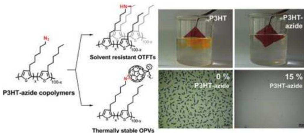
Figure I-30 : Structure moléculaire du P3HT-Azoture ; Influence de l'insertion de ce composé sur les propriétés de résistance thermique et chimique
