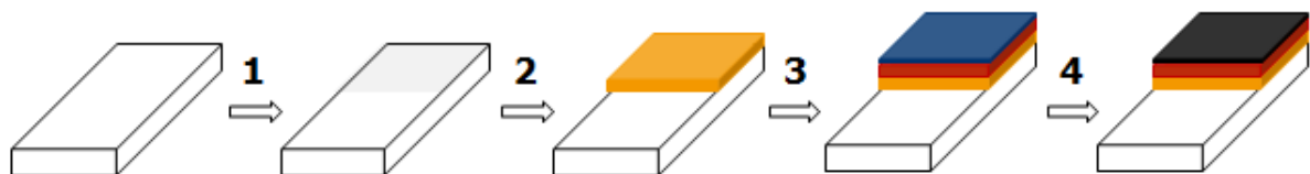
Figure 4.4: Représentation schématique des différentes étapes de synthèse de l'électrodéposition-anodisation du cuivre.
