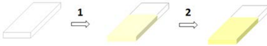
Figure 3.2: Représentation schématique des différentes étapes de synthèse des films de pérovskite par voie sol-gel.
