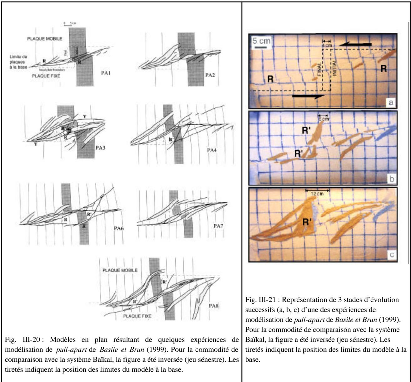
Fig. III-20 : Modèles en plan résultant de quelques expériences de modélisation de *pull-apart* de Basile et Brun (1999). Pour la commodité de comparaison avec la système Baïkal, la figure a été inversée (jeu sénestre). Les tiretés indiquent la position des limites du modèle à la base.
