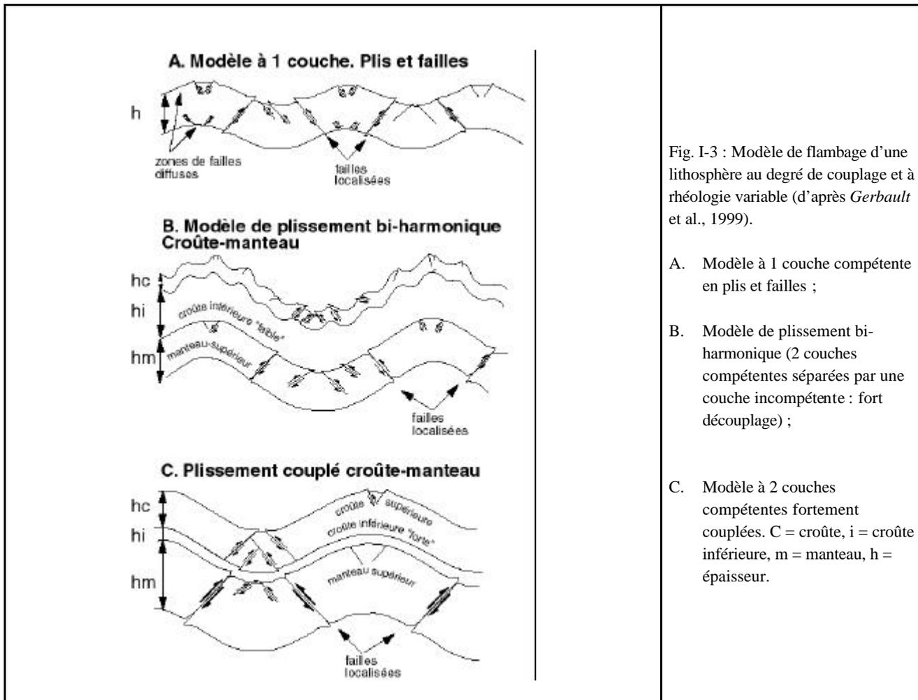
Fig. I-3 : Modèle de flambage d'une lithosphère au degré de couplage et à rhéologie variable (d'après Gerbault et al., 1999).
