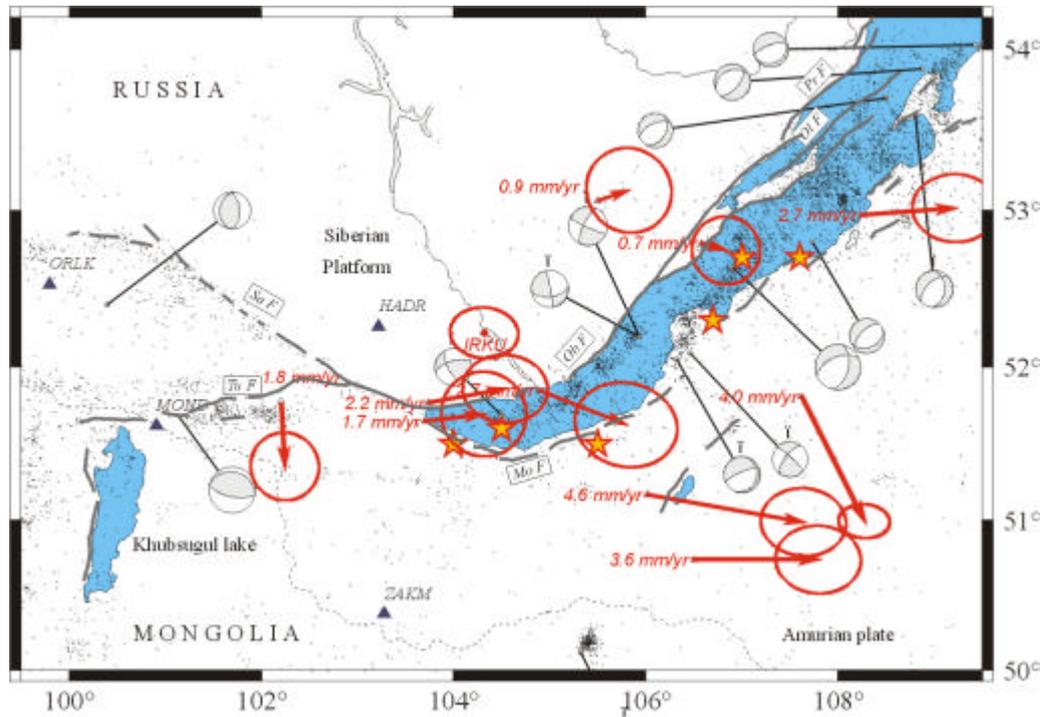
Fig. III-16: Champ de vitesse instantané (référence : IRKU) obtenu après 4 campagnes de mesures GPS réalisées entre 1994-1997 (Calais et al., 1998, Pub. 8). Les points représentent la sismicité 1960-1997, les ballons les mécanismes au foyer principaux, les étoiles jaunes les épicentres des grands séismes historiques.
