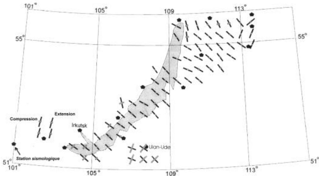
Fig. III-13 : Champ de déformation déduit des l'inversion des mécanismes aux foyers du rift Baïkal par la méthode de *S. Yunga*, détaillée dans *Lukk et al. (1995)*, communiquée par *V. Melnikova* (Irkoutsk). La méthode tend à lisser les directions d'axes.
