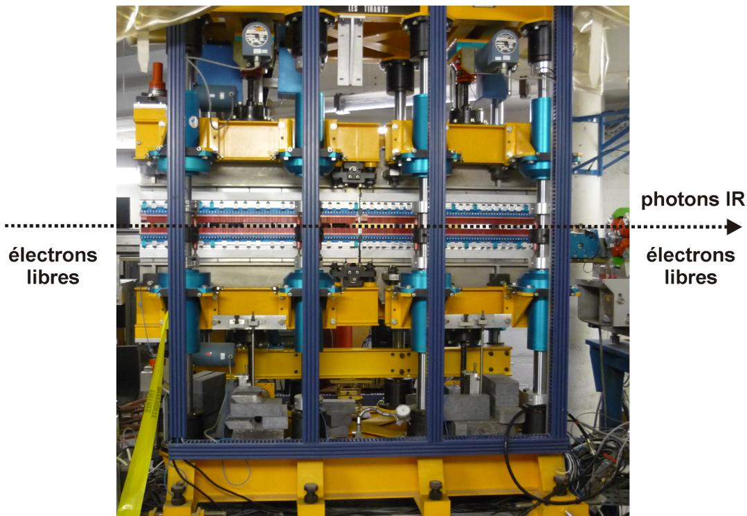
FIGURE 3.2 – Photo de l'onduleur du laser à électrons libres CLIO. Les deux rangées d'aimants permanents sont situées au niveau des éléments rouge cuivré. Les pistons (en bleu ciel) permettent l'ouverture et la fermeture de l'onduleur en éloignant ou rapprochant les deux rangées d'aimants
