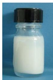
Figure 64. Dispersion de nanoparticules de CuSCN dans l'IPA à 2,5 % en masse
