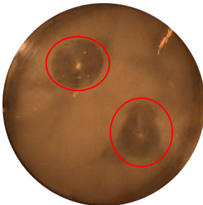
Figure.3- 8 Image capturée des visualisations avec les cristaux liquides thermochromiques montrant l'apparition de l'instabilité après 7h d'attente à partir de l'augmentation de la puissance Q_t=35W , les cercles rouges indiquent les premières cellules de convections. (les bulles d'air capturés dans l'image sont tous dans la circulation de l'eau froide)
