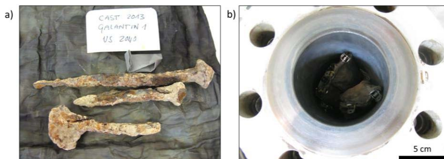
Figure 26 : Lots d'objets archéologiques du site du Castellet conditionnés pour un traitement subcritique, a) avant traitement, b) dans le réacteur.
