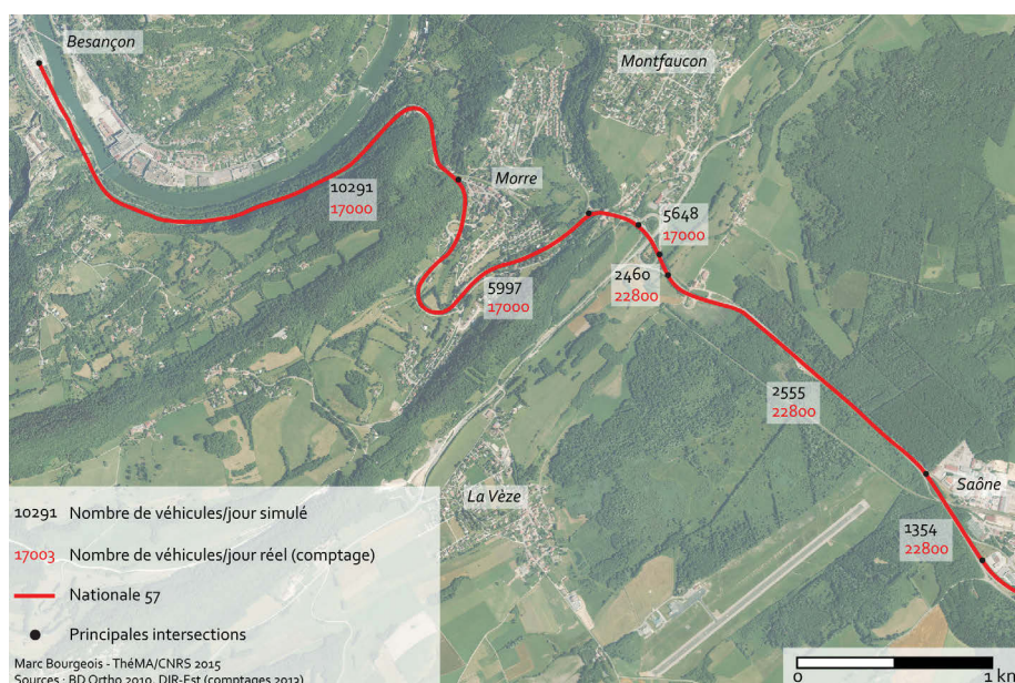
Figure 5.14 • Illustration des différences entre trafic réel et trafic simulé. Exemple de la côte de Morre en direction de Pontarlier (N57).
