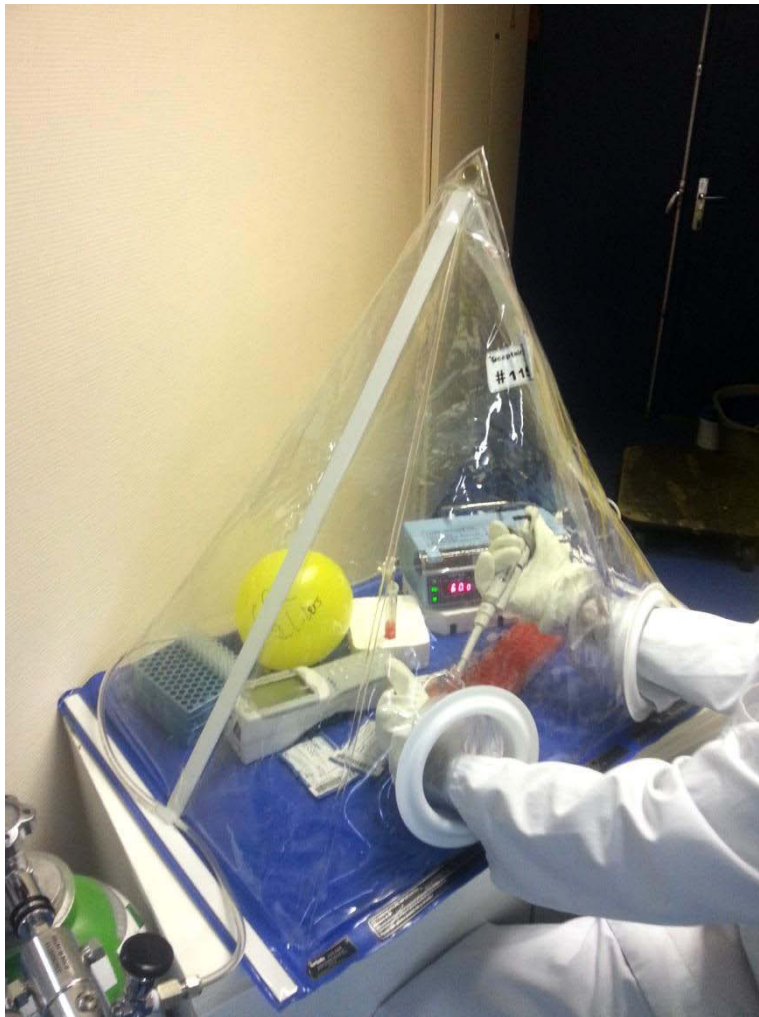
Image de microfiltration en hypoxie sous tente Plastique hermétique au laboratoire de laboratoire de Parasitologie et de Mycologie de la pitié Salpêtrière (CIMI-Paris /U1135) Paris/ France
