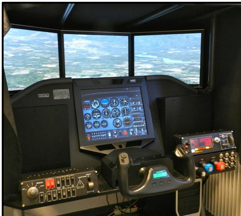
Figure 10.2. L'environnement de simulation de la plateforme PILOTE 2
