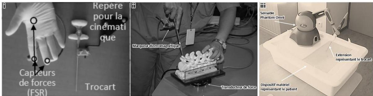
Figure 5.3. (i), (ii) Instrumentations pour le recueil des données gestuelles et haptiques relatives à la manipulation du trocart. (iii) Bras haptique et dispositif matériel dans l'environnement de simulation.
