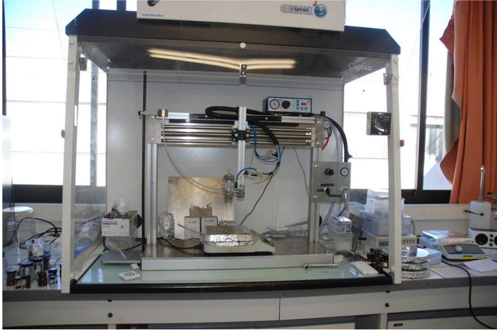
Figure II.1. Photographie du montage de dépôt par spray-coating
