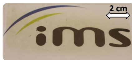
Figure II.17. Photographie d'un film réalisé avec 20 passages de spray-coating d'une solution de Ag NWs (Seashell) à 0,5 mg/mL dans le méthanol et posé sur le logo du laboratoire
