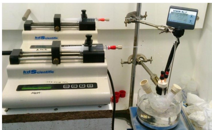
Figure I.25. Photographie d'un montage de synthèse de Ag NWs par le procédé polyol (crédit photo : J. Idier, CRPP)
