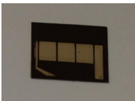
Figure IV.35. Photographie d'un module OPV de 4 cellules connectées en série, réalisé à partir du procédé de fabrication de cellules OPV sur substrat souple développé au chapitre III (taille du substrat : 15 x 15 mm 2 )
