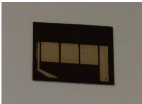
**Figure IV.35. Photographie d'un module OPV de 4 cellules connectées en série, réalisé à partir du procédé de fabrication de cellules OPV sur substrat souple développé au chapitre III (taille du substrat : 15 x 15 mm<sup>2</sup>)**
