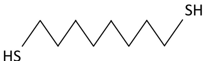
**Figure III.35.** Structure chimique du 1,8-octanedithiol (ODT)
