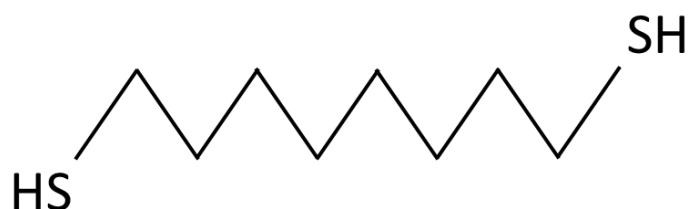
Figure III.35. Structure chimique du 1,8-octanedithiol (ODT)
