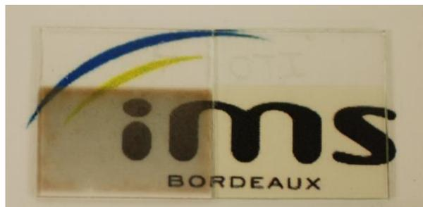
**Figure II.11. Photographie d'un film de Ag NWs réalisé avec 60 passages à gauche et d'un substrat ITO à droite (taille des substrats : 15x15 mm<sup>2</sup>)**
