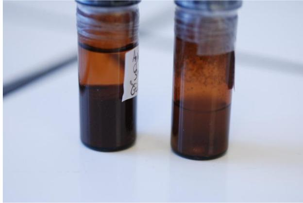
Figure II.5. Photographie d'une fiole de Ag NWs dispersés dans le méthanol laissée reposer pendant plus d'une semaine (gauche) et une fiole de la même dispersion agitée après avoir reposé pendant plus d'une semaine (droite)
