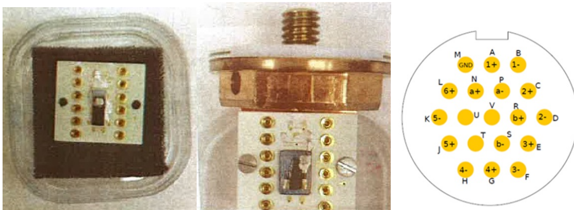
Figure 94: Photo de l'échantillon contacté sur une plaque électronique (gauche) ; Photo de la même plaque vissée au porte échantillon utilisé pour les mesures (milieu). Ce porte échantillon a été vissé à une canne de transfert de manière à permettre le contact électrique ; Schéma du connecteur vu de dessus (droite).
