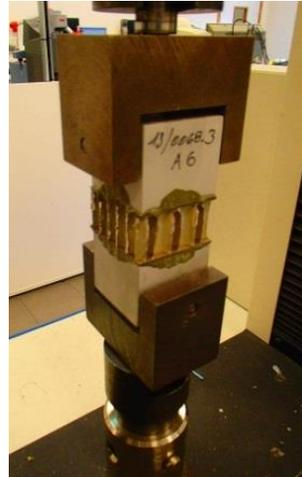
Figure 81. Montage d'un essai de traction perpendiculaire
