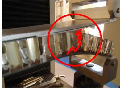
Figure 123. Eprouvette REF-I-C-04 à 06 : rupture du Nida et propagation à l'interface peau coccute / Nida
