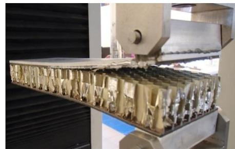
Figure 122. Courbes de propagation REF-1-B-04 à 06 et photo du montage DCB sandwich
