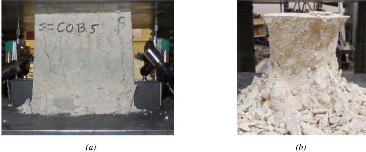
*Figure III.1-15 : Essai de compression sur bloc calcaire 20\*20\*20 cm<sup>3</sup>. (a) Fissuration perpendiculaire au sens de chargement. (b) Profil de rupture de l'éprouvette avec cône de frettage.*
