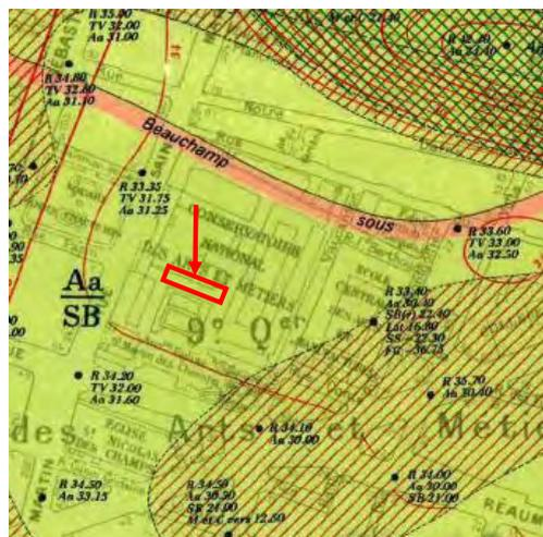
Figure II.4-10: Situation géologique du sol environnant. Extrait de la carte géologique à 1/5000 des 1<sup>er</sup>, 2<sup>ème</sup>, 3<sup>ème</sup> et 4<sup>ème</sup> arrondissements
