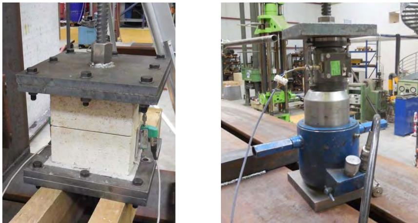
Figure III.1-16 : Dispositif d'essai de traction des blocs calcaires. (a) Eprouvettes équipées de capteurs de déplacements. (b) Vérin et Dynamomètre.
