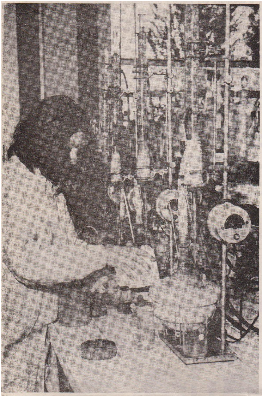
Figure 11 : Une aide-chimiste près d'un appareil pour le dosage de l'acide sulfurique des colophanes (années 1970)
