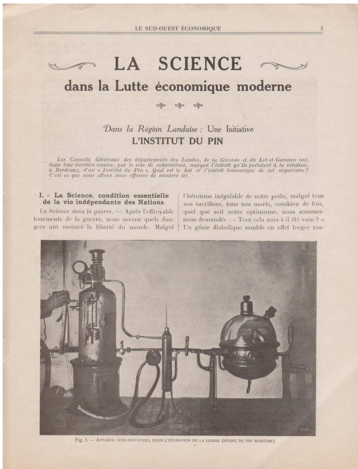
Figure 2 : Appareil semi-industriel pour l'épuration de la gemme (1921)
