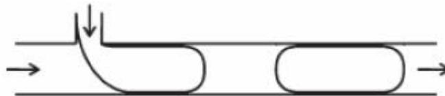
Figure I.12 : Formation d'un coude à l'interface de deux phases avant le détachement d'une gouttelette à la jonction en T dans un canal microfluidique [I-25].
