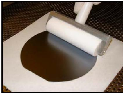
Figure II.27 : Roulette en Téflon pour transférer une couche de SU-8 sur un autre substrat [II-19].
