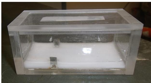
**Figure A.2 : Enceinte d'essai, 97% d'humidité relative.**
