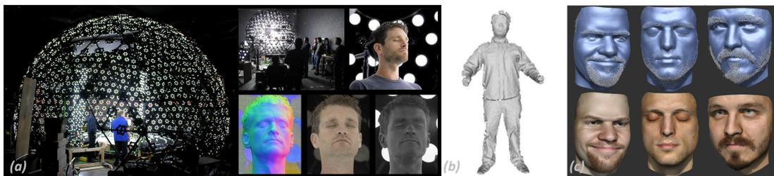
**FIGURE 2.26** – *Scanner un utilisateur : peau utilisateur-spécifique. (a) Light Stage 6 [21]. (b) Scanner à partir d'un capteur léger [94]. (c) Capture faciale : peau et poils [68].*
