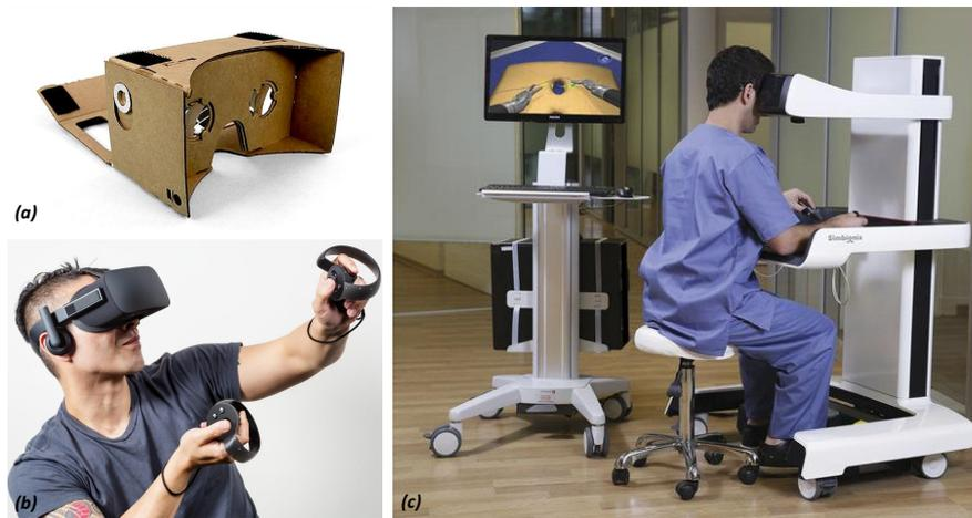
**FIGURE 2.19** – Visiocasques. (a) Google Cardboard. (b) Oculus Rift et Oculus Touch. (c) Simulateur pour chirurgie robotique - RobotiX Mentor.
