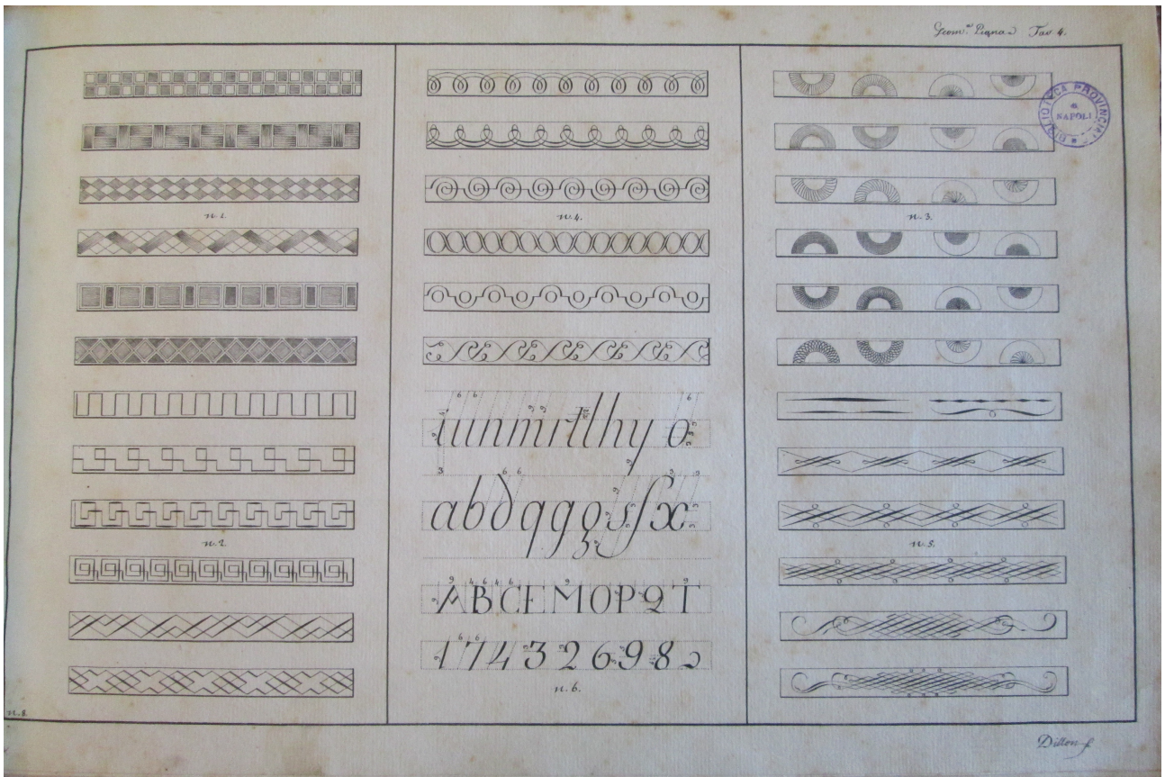
Figura 37 G. Dillon, Lezioni di disegno geometrico , Tavola 4, disegno 1 Tratteggio rettilineo in ogni direzione; disegno n. 2 Esercizi di linee rette senza riga e compasso; disegno n. 3 Tratteggio circolare; disegno n. 4 Esercizi per il tondeggio; disegno n. 5 I metodi da far le cifre; disegno n. 6 Proporzioni delle lettere e numeri elementari, 1790
