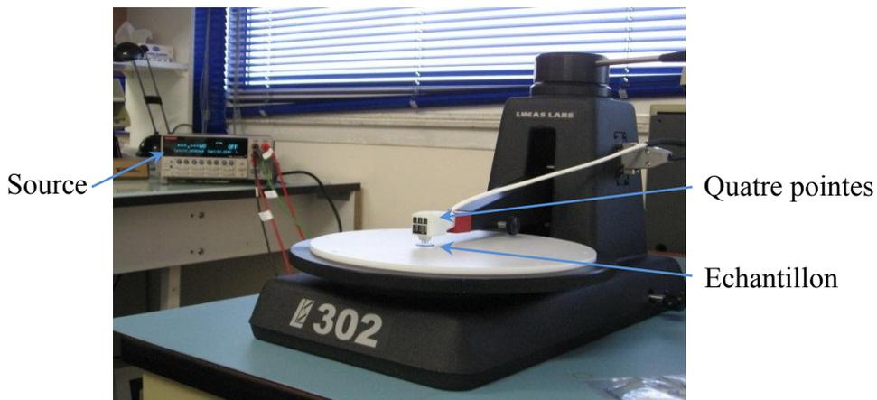
**Figure 2.14 - Montage utilisé pour les mesures de conductivité continue par la méthode des quatre points.**
