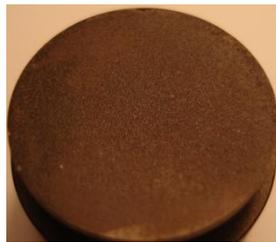
*Figure D.11 Photographie de l'échantillon 103F après son émergence de la solution caustique*
