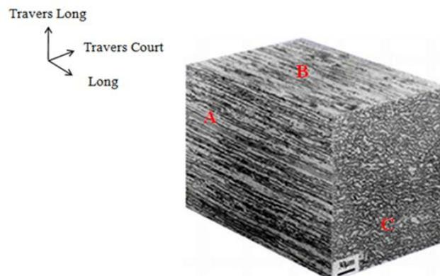
Figure IV. 1 Microstructure d'un acier duplex composé de 50%-austénite et 50%-ferrite
