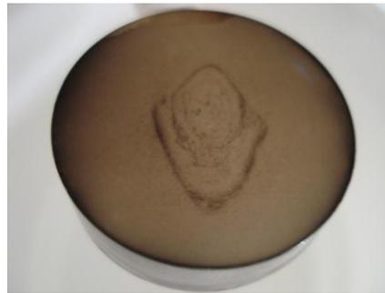
*Figure III. 45 Photographie de l'échantillon 304L-101F après 240h dans le milieu caustique*
