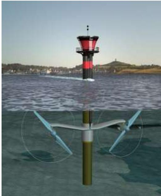
Figure 2-20. Hydrolienne Seagen avec un pieu fiché dans le fond
