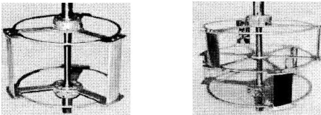
Figure 2-3. Montage original (à gauche) et décalé à 60° (à droite) de deux rotors Darrieus à trois pales droites
