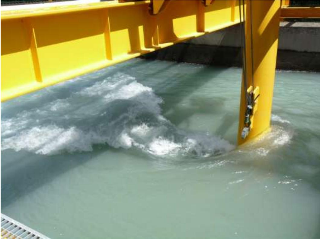
Figure 7-18. Ressaut local avec l'hydrolienne en fonctionnement.  $V= 2 \text{ m/s}$
