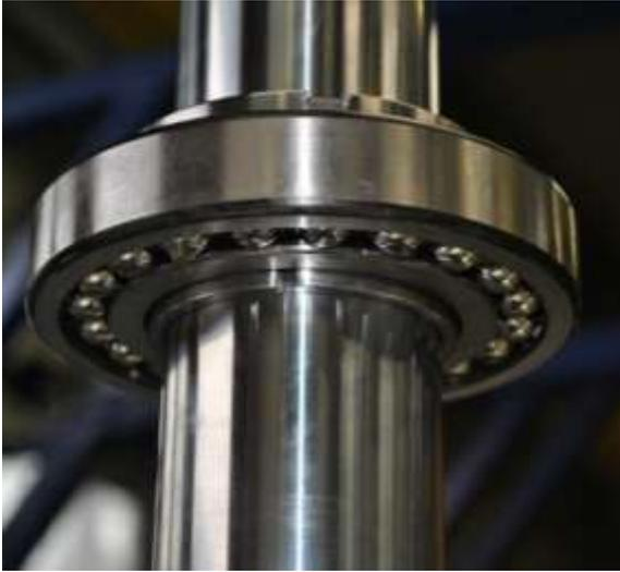
Figure 6-17. Roulement à billes monté sur un manchon de serrage
