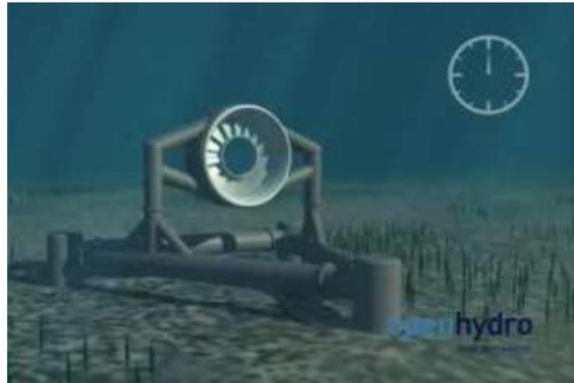
Figure 2-22. Hydrolienne à centre ouvert montée sur un tripode gravitaire. Source : OpenHydro
