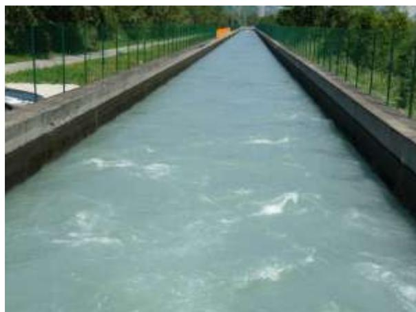
Figure 7-17. Sillage de l'hydrolienne en fonctionnement.  $V = 2$  m/s
