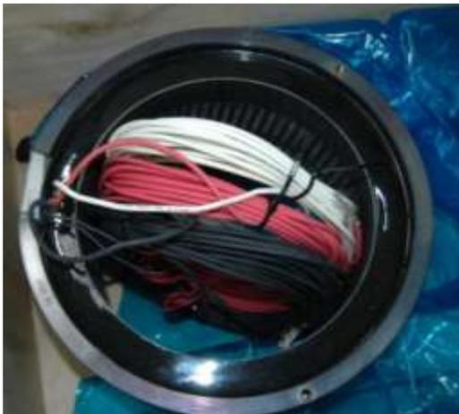
Figure 6-21. Stator à bobinage triphasé (produit Parker)
