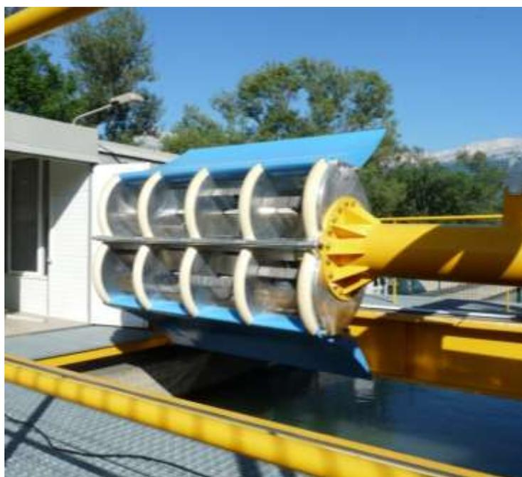
Figure 7-10. Hydrolienne carénée avant la mise à l'eau
