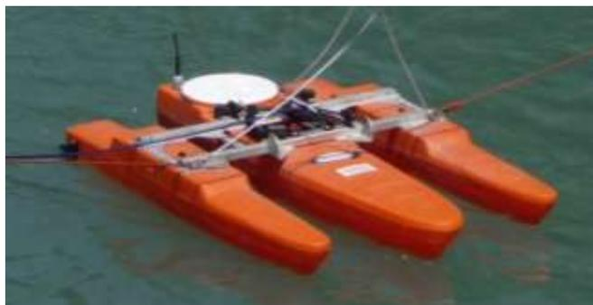
Figure 7-1. ADCP Workhorse Rio Grande sur le trimaran Riverboat Oceanscience. Source : ENSE3
