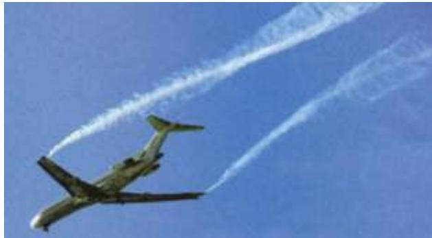
**Figure 3-29. Observation des tourbillons de bout d'aile lors du vol d'un avion**
