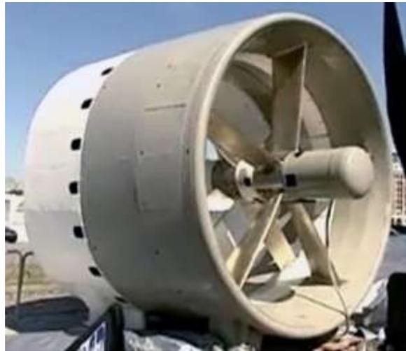
Figure 1-20. Hydrolienne TREK de RER
