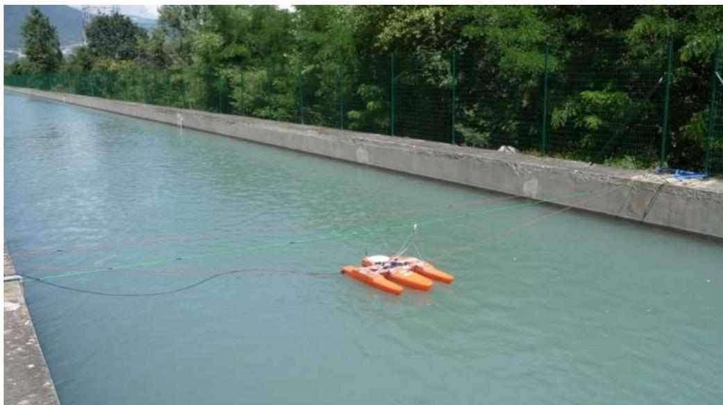
Figure 7-4. Courantomètre ADCP en fonctionnement sur le canal
