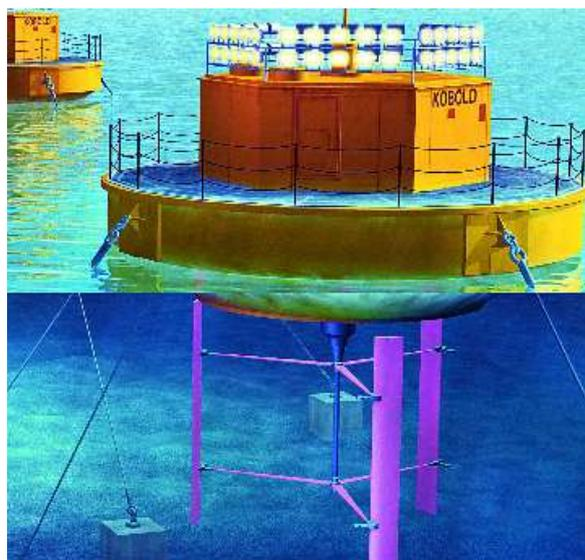
Figure B-13. Structure flottante du Projet Enermar
