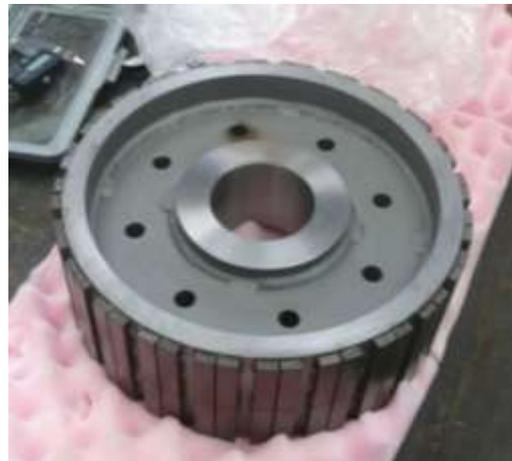
Figure 6-22. Rotor à aimants permanents (produit Parker)
