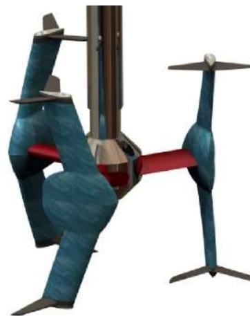
Figure 3-33. Turbine à flux transverse équipée de winglets
