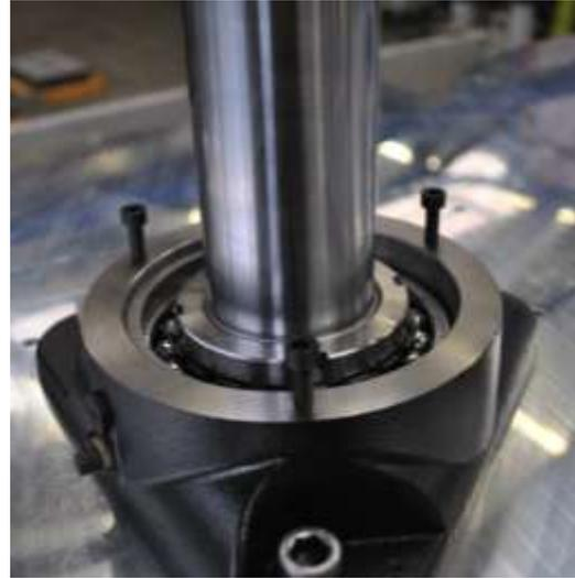
Figure 6-18. Corps du palier fixé sur la plaque supérieure de l'hydrolienne
