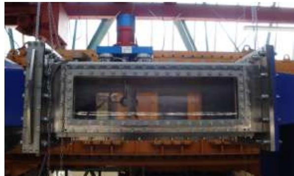
Figure 4-8. Veine d'essai et balance d'efforts
