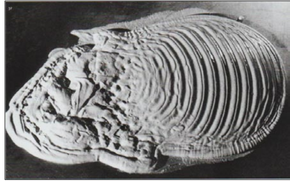
fig. 18: Hans Jenny, étude sur les ondes sonores traduites dans des matières visqueuses. Les vagues sont le résultat de hautes fréquences infligées à la matière. Greg Lynn emprunte cette image d'expérimentation à H. Jenny, Cymatics, Wave Phenomena, Vibrational effects, Harmonic Oscillations with their structure, Kinetics and Dynamics . Basel : Basilius Press, 1974. Source : G. Lynn, Animate Form , 1999. p.38. © H. Jenny.
