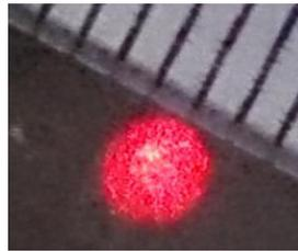
Figure 5.3 : mesure de la tache focale.
