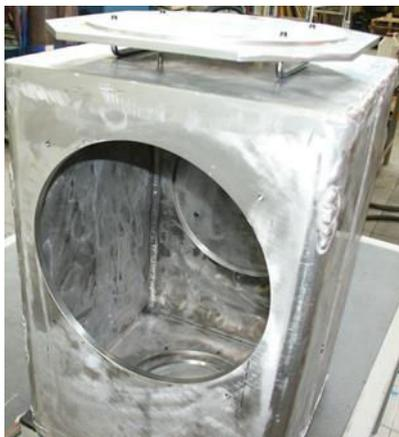
Figure 3.2 : enceinte en aluminium.
