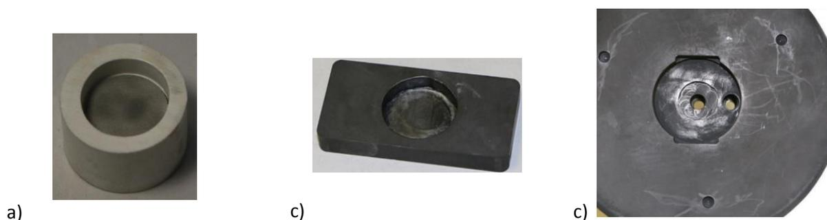
**Figure 3.5 : vues d'un creuset en nitrure de bore (a), de son support (b) et de la partie centrale chauffée (c).**
