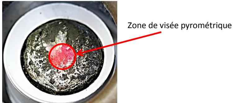
Figure 4.16: exemple de fer oxydé.
