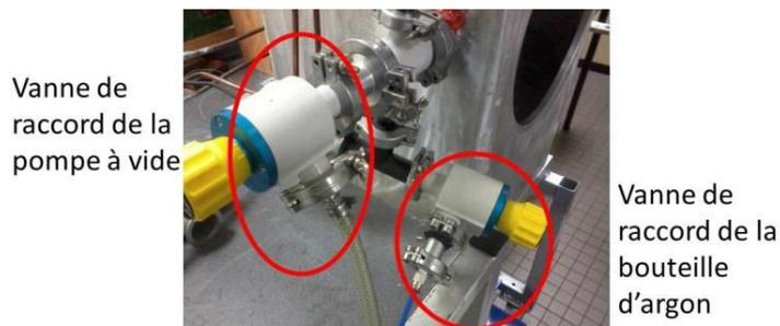
Figure 3.7 :raccords pompe à vide et bouteille d'argon.
