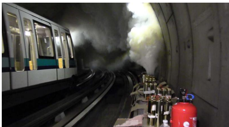
Figure 30. Simulation d'un feu de pneus dans le métro
