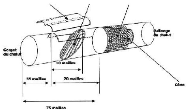
Système de grille adapté au chalut avec une porte de sortie pour les tortues
