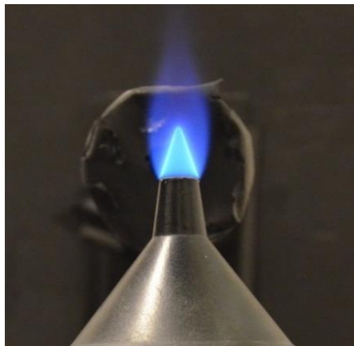
Figure 2-2 : Photographie d'une flamme de prémélange laminaire de méthane-air stabilisée sur un brûleur de référence de type Bunsen.
