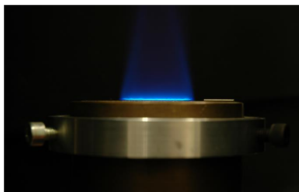
Figure 2-3 : Photographie d'une flamme de prémélange laminaire de méthane air stabilisée sur un brûleur Mckenna [148].
