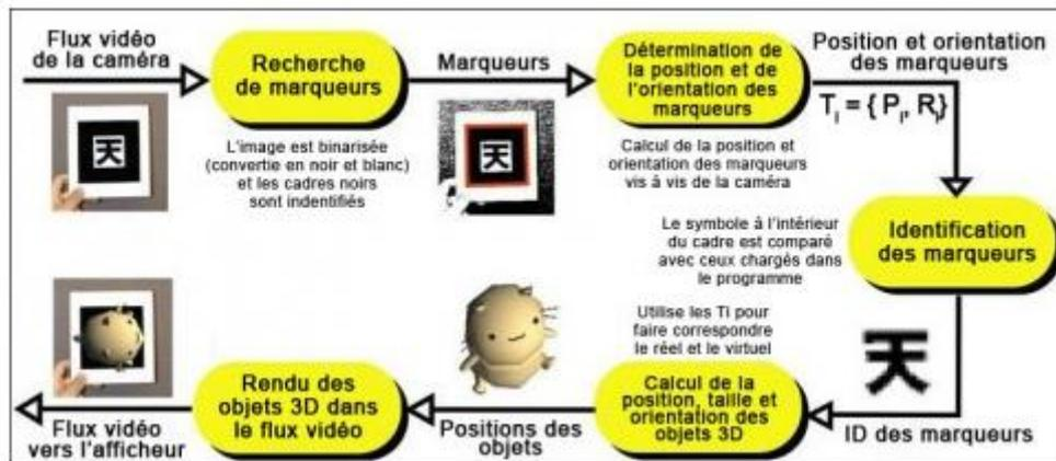
Figure I-18. Traitement d'image utilisé dans ARToolKit [32]
