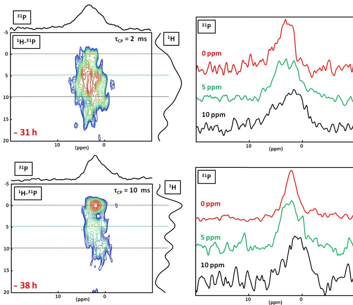
Figure 4-19 : Spectres 2D  $^1\text{H} \rightarrow ^{31}\text{P}$  HETCOR CP MAS d'une plaque de Randall *unique*. Sonde 2,5 mm. Fréquence de rotation : 14 kHz. En haut :  $\tau_{\text{CP}} = 2$  ms et à sa droite, tranches extraites de l'expérience HETCOR, délai de relaxation : 2 s, NS = 2800 et 20 incréments  $t_1$ . En bas :  $\tau_{\text{CP}} = 10$  ms et à sa droite, tranches extraites de l'expérience HETCOR, délai de relaxation : 2 s, NS = 2800 et 24 incréments  $t_1$ .
