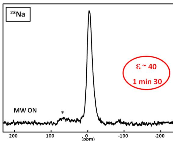
Figure 3-24 : Spectre <sup>1</sup>H → <sup>23</sup>Na DNP CP MAS de CHAp, enrichie en <sup>13</sup>C, et sodée (1,23 wt%) (précurseur : NaH<sup>13</sup>CO<sub>3</sub>), AMUpol/D<sub>2</sub>O/H<sub>2</sub>O. RO = 8 kHz. NS = 16, τ<sub>CP</sub> = 6 ms, délai de relaxation <sup>1</sup>H : 15 s. La bande de rotation est indiquée par \*.
