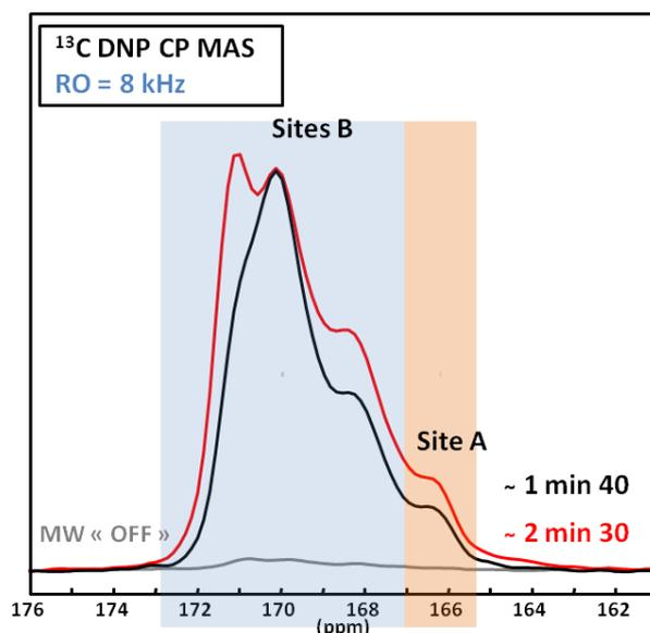
Figure 3-21 : Spectres normalisés (ON)  $^{13}\text{C}$  DNP CP MAS de l'échantillon CHAp, enrichi en  $^{13}\text{C}$  :  $^1\text{H} \rightarrow ^{13}\text{C}$  CP (en rouge) et  $^1\text{H} \rightarrow ^{31}\text{P} \rightarrow ^{13}\text{C}$  double CP (en noir). MW OFF : absence d'irradiation microonde. Pour CP d1 = 8,5 s et NS = 16. Pour double CP d1 = 6,5 s et NS = 16.
