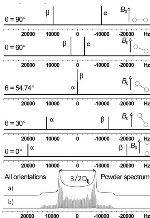
Figure 2-15 : Influence du couplage dipolaire homonucléaire a) sur le spectre statique et b) en rotation à l'angle magique. Adapté de [14]. Ici, on fixe  $\nu_0 = 0$  Hz et on suppose une paire de spins strictement isolée.
