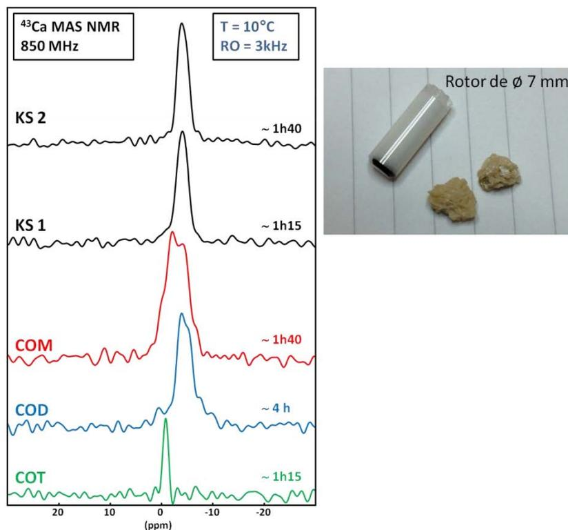
Figure 4-9 : Spectres  $^{43}\text{Ca}$  MAS des deux calculs rénaux, KS 1 et KS 2. Les spectres du COM (en rouge), du COD (en bleu) et du COT (en vert) synthétiques sont présentés pour comparaison. Sonde MAS 7 mm, 850 MHz.
