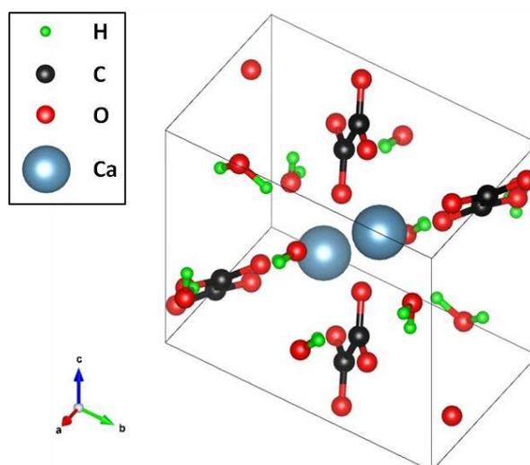
Figure 1-4 : Représentation de la structure cristalline de la caoxite (COT) [17].
