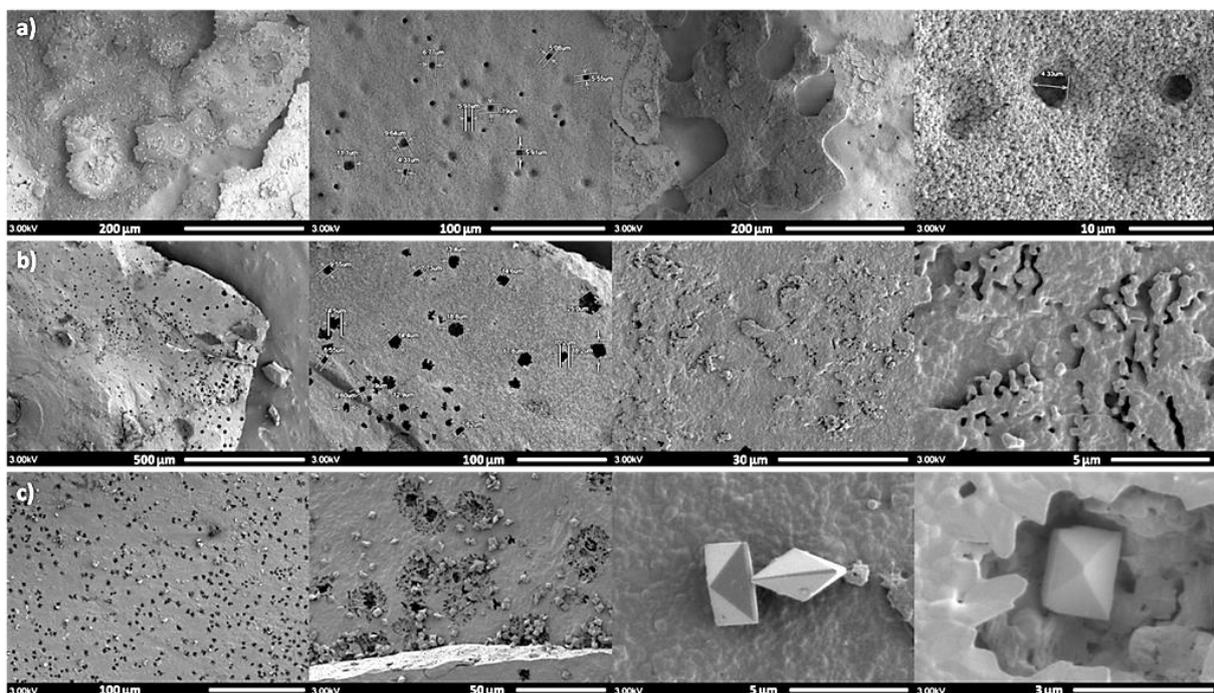
**Figure 5-30 : Images MEB des pastilles d'HAp : expériences de contrôle. a) HAp dans l'eau (pH = 3,7). b) HAp dans la solution aqueuse contenant des ions citrates. c) HAp dans une solution aqueuse contenant l'extrait de thé vert.**
