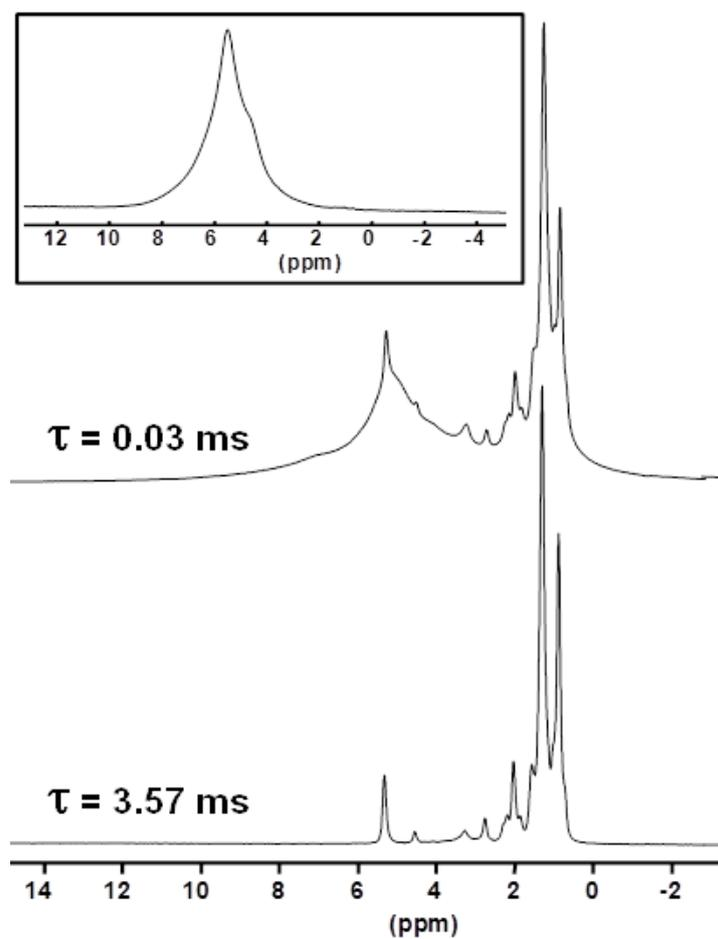
Figure 4-6 : Echos de Hahn  $^1\text{H}$  MAS à temps de refocalisation ( $\tau$ ) variable dans le cas du calcul rénal KS 3.  $\tau$  est synchronisé avec la fréquence de rotation MAS (ici 30 kHz). Sonde MAS 2,5 mm, 700 MHz. NS = 64, délai de relaxation  $^1\text{H}$  : 5 s. Insert : spectre obtenu dans les mêmes conditions pour la phase COM synthétique.
