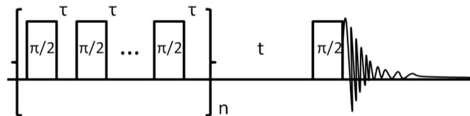
Figure 2-21 : Séquence d'impulsions saturation-récupération.
