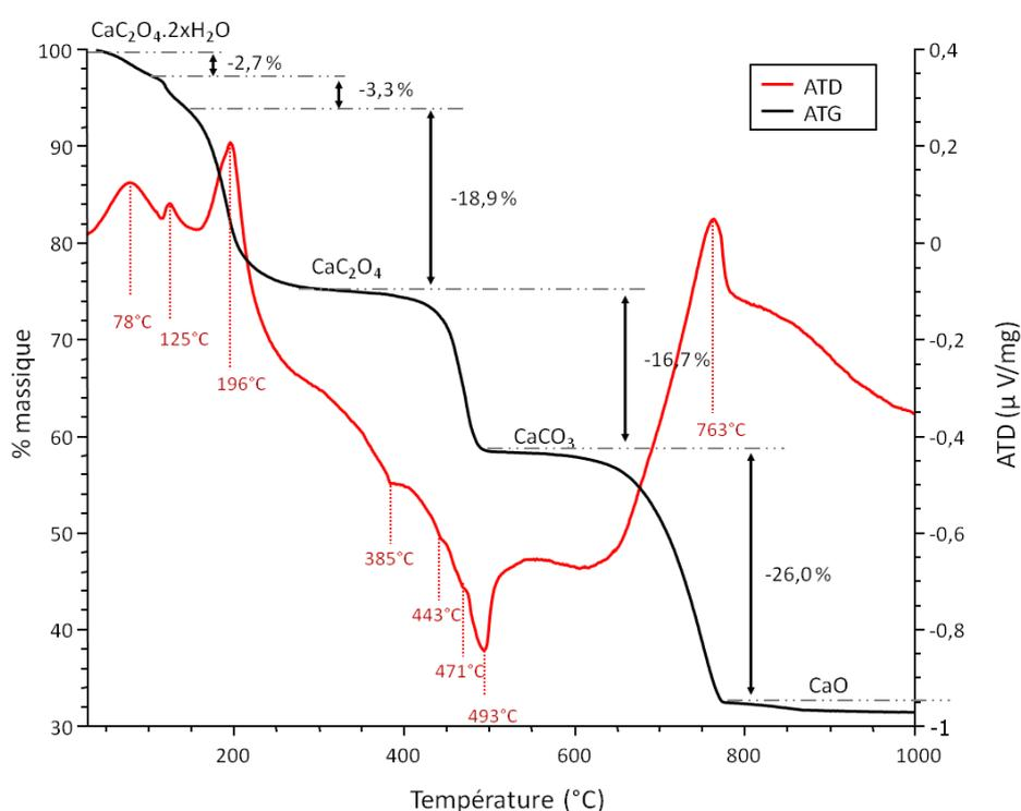
Figure 1-15 : ATD/TG de la phase COD synthétique, 5°C/min sous flux d'air.
