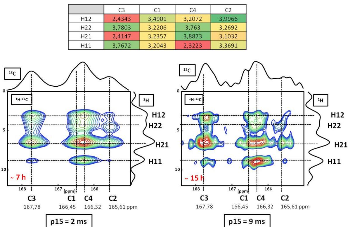
Figure 3-31 : Spectres 2D  $^1\text{H} \rightarrow ^{13}\text{C}$  DNP HETCOR CP MAS du COM (AMUpol/ $\text{D}_2\text{O}/\text{H}_2\text{O}$ ) à deux temps de contacts différents ( $\tau_{CP} = 2$  et 9 ms).
