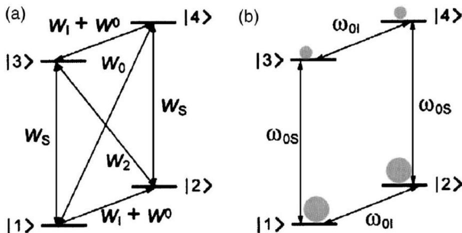
Figure 2-24: Diagramme d'énergies impliqué dans l'effet Overhauser. (a) vitesses de transitions importantes pour l'OE. (b) Population à l'équilibre thermique pour un système de spins à deux niveaux. La population de spin est représentée schématiquement en gris. D'après [79].
