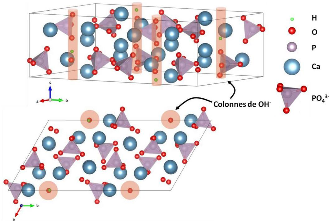
Figure 1-21 : Structure cristalline de l'hydroxyapatite stœchiométrique monoclinique [70].
