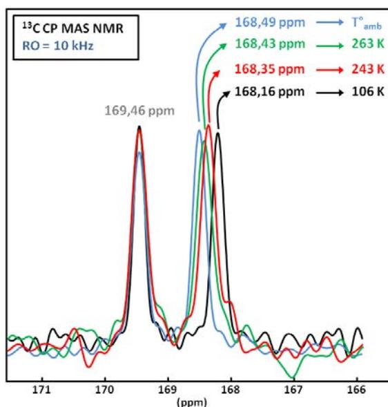
Figure 3-14 : Spectres  $^{13}\text{C}$  CP MAS (700 MHz) de la phase COT (fréquence de rotation : 10 kHz) en fonction de la température : de la température ambiante à  $-30^\circ\text{C}$ . Le spectre en noir a été enregistré à  $-167^\circ\text{C}$  lors d'une expérience de DNP CP MAS (400 MHz et fréquence de rotation : 8 KHz – voir partie 4 a).).
