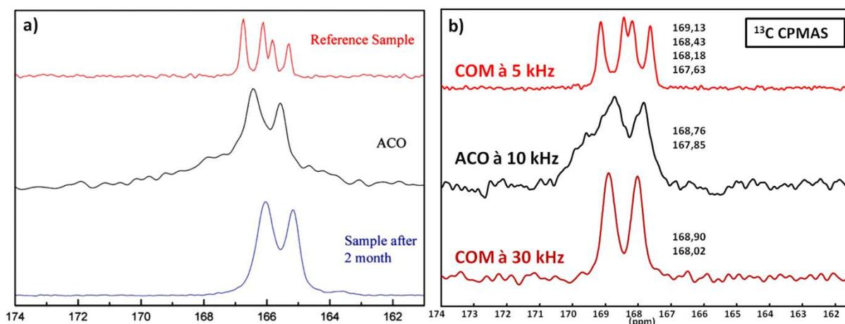
Figure 3-9 : Spectres  $^{13}\text{C}$  CP MAS a) spectre de COM en rouge et ACO en noir et bleu d'après [16] b) en haut spectre de COM à RO = 5 kHz, au milieu spectre ACO à 10 kHz et en bas spectre de COM à 30 kHz.
