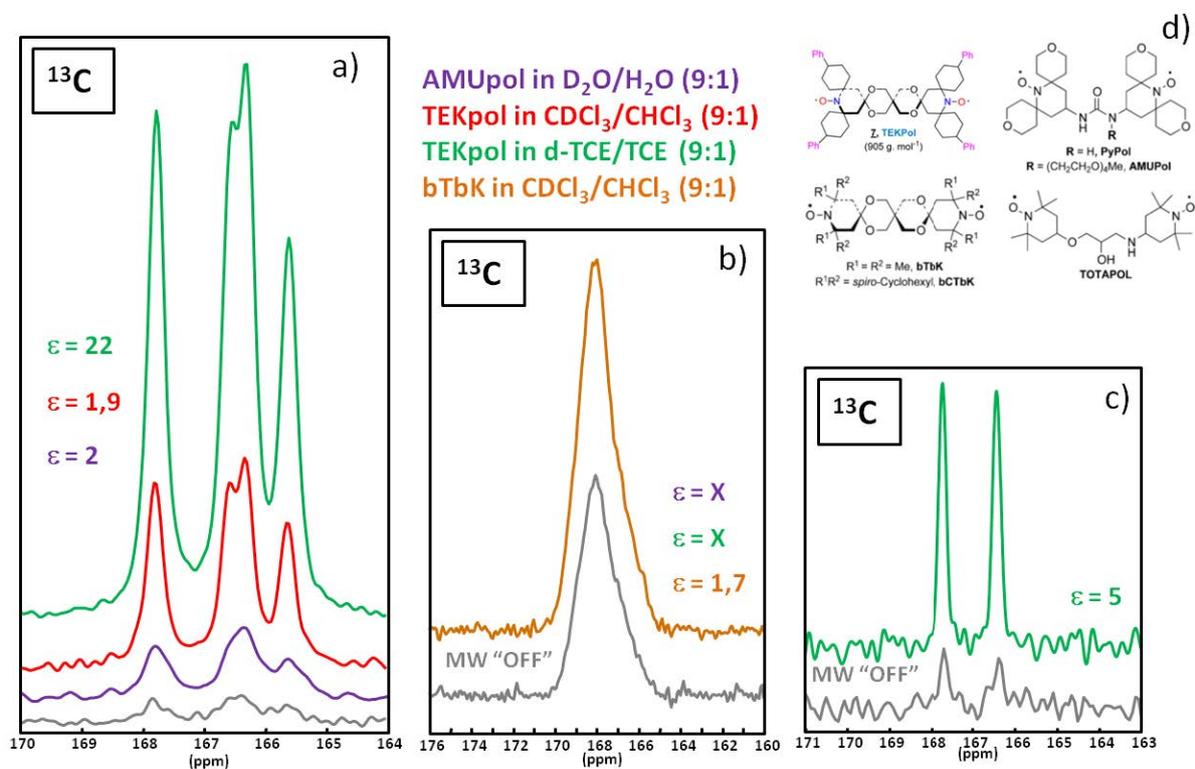
Figure 3-28 : Tests d'efficacité ( $^{13}\text{C}$  DNP CP MAS) des combinaisons {solvant/biradical} pour les trois phases d'oxalate de calcium hydraté, COM, COD et COT. a) COM. b) COD. c) COT d) Schémas des biradicaux d'après [56], [68].
