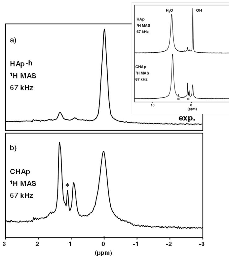
Figure 3-16 : a) spectre  $^1\text{H}$  ultra fast MAS (67 kHz) (obtenu à 500 MHz) de nanoparticules d'apatite obtenues par précipitation en voie aqueuse et b) spectre ultra fast  $^1\text{H}$  ultra fast MAS (67 kHz) (obtenu à 500 MHz) de nanoparticules d'HAp carbonatée (CHAp) (voir la synthèse dans le Chapitre 1). Insert : spectres complets montrant la résonance attribuée à  $\text{H}_2\text{O}$ . HAp-h : phase hexagonale.
