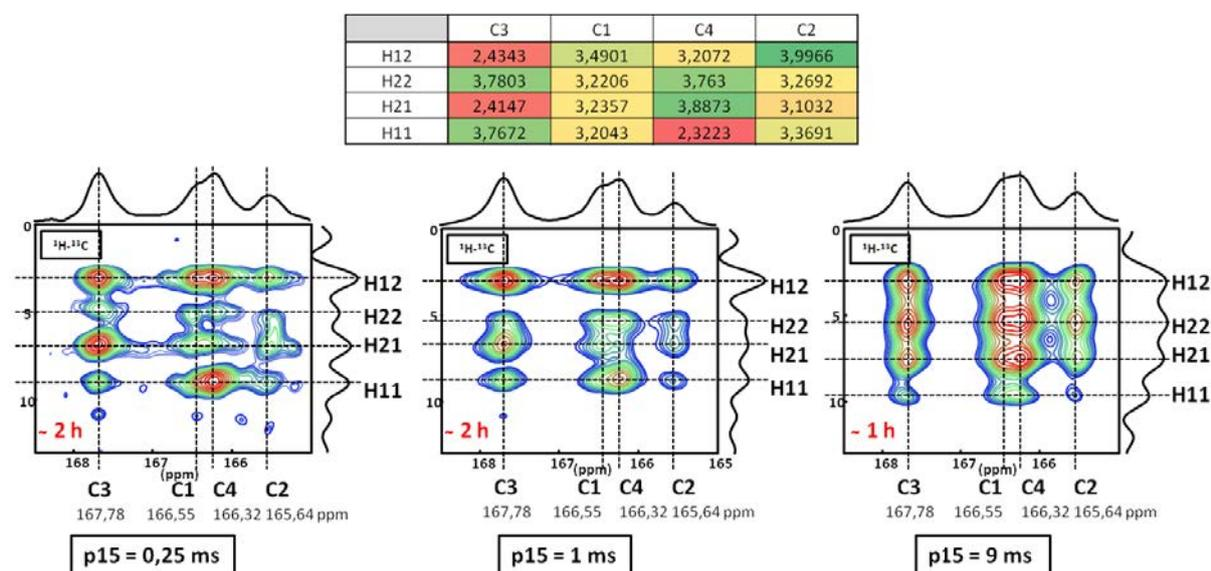
Figure 3-29 : Spectres 2D  $^1\text{H} \rightarrow ^{13}\text{C}$  DNP HETCOR CP MAS du COM (TEKpol/TCE-d/TCE) (90/10) à trois temps de contact ( $\tau_{\text{CP}}$ ) différents. Le tableau présente les distances C-H extraites de l'optimisation de la structure du COM par DFT [24]. Code couleurs : rouge : C-H < 2,44 Å ; jaune : 3,20 Å < C-H < 3,27 Å ; vert : 3,35 Å < C-H.
