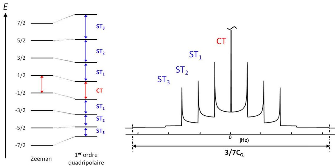
Figure 2-10 : Niveaux d'énergie pour un noyau de spin  $I = 7/2$  avec  $\gamma < 0$  (ce cas s'applique au  $^{43}\text{Ca}$ ). Les effets de l'interaction quadripolaire au premier ordre n'affectent pas la CT (ici  $\eta_Q = 0$ ). La CT est centrée arbitrairement à 0 Hz.
