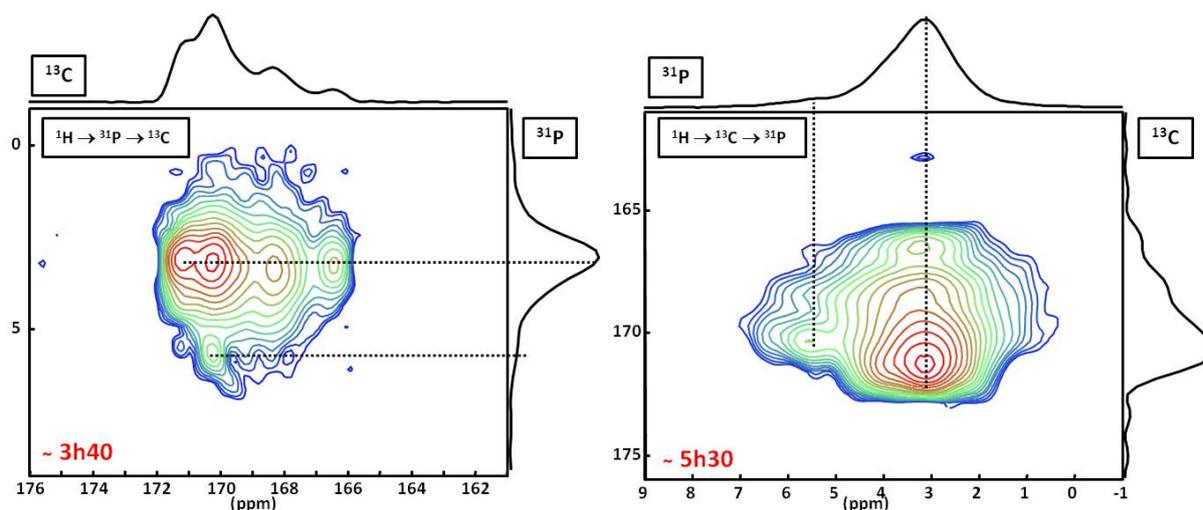
Figure 3-22 : Spectres 2D HETCOR double CP :  $^1\text{H} \rightarrow ^{31}\text{P} \rightarrow ^{13}\text{C}$  et  $^1\text{H} \rightarrow ^{13}\text{C} \rightarrow ^{31}\text{P}$  de CHAp (enrichie en  $^{13}\text{C}$ ). AMUpol/D<sub>2</sub>O/H<sub>2</sub>O (90/10).
