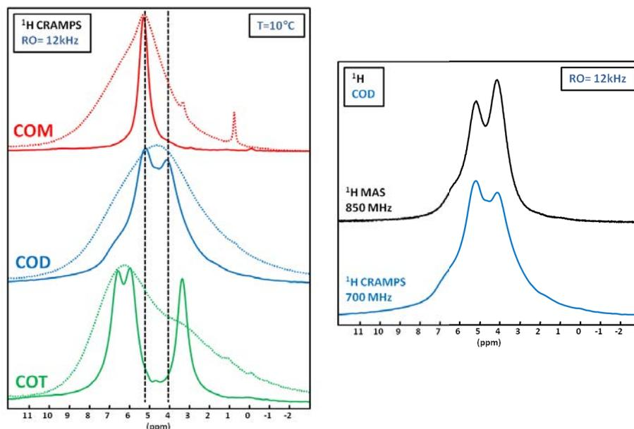
Figure 3-1 : A gauche : Spectres RMN  $^1\text{H}$  CRAMPS des trois hydrates d'oxalates de calcium, COM, COD et COT obtenus à l'aide de la séquence DUMBO [7]. RO (fréquence de rotation), d1 (délai de relaxation) = 10 s. NS = 20. LB (line broadening) = 10 Hz. Les spectres MAS de chacune des phases sont ajoutés en pointillés à RO équivalente. A droite : comparaison des spectres obtenus sur le COD à 700 MHz (DUMBO) (en bleu) et à 850 MHz (ultra fast MAS 80 kHz) (en noir).
