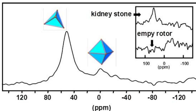
Figure 4-11 : Spectre  $^{27}\text{Al}$  MAS du calcul rénal KS 3. Rotation MAS : 5 kHz, sonde 7mm, 7,0 T, 300 MHz. Temps d'expérience : environ 12 heures. Les zones caractéristiques des atomes Al en coordinence 4 et 6 sont indiquées. Insert : spectres d'un rotor vide en rotation et de l'échantillon KS 3 (2 heures). Ce test permet d'éliminer une contribution potentielle du rotor dans le spectre de KS 3.
