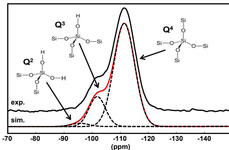
Figure 4-10 : Spectre  $^{29}\text{Si}$  MAS du calcul rénal KS 3. La simulation du spectre fait intervenir des entités  $\text{Q}^4$  et  $\text{Q}^3$  (majoritaires) et  $\text{Q}^2$  (très minoritaires). 7,0 T, 300 MHz. Rotation MAS : 5 kHz, sonde 7mm. Découplage  $\{^1\text{H}\}$  de type SPINAL-64 [15], [16]. Délai de relaxation : 600 s. NS = 248 (environ 41 heures).
