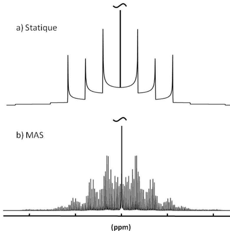
Figure 2-16 : a) Spectre statique relatif à un noyau de spin  $I = 7/2$  soumis à l'interaction quadripolaire au 1<sup>er</sup> ordre et  $\eta_Q = 0$ . b) Spectre MAS correspondant. ( $\nu_{rot} \ll C_Q$ ).
