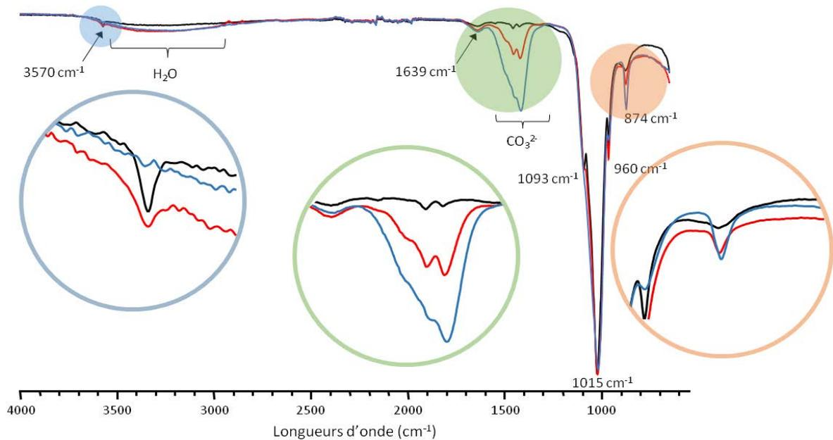
Figure 1-24 : Spectres FTIR (ATR) d'hydroxyapatites synthétiques. HAP (en noir) laissée à l'air pendant 24 hrs, HAP carbonatée à l'air pendant 5 jours (en rouge), HAP carbonatée par NaHCO<sub>3</sub> (en bleu).
