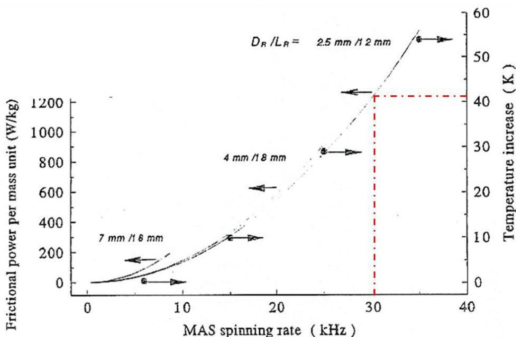
Figure 3-5 : Courbes représentant l'élévation de température de l'échantillon (en K) à l'intérieur du rotor et en rotation MAS pour un type de sonde donnée : 7, 4, et 2,5 mm (catalogue BRUKER).
