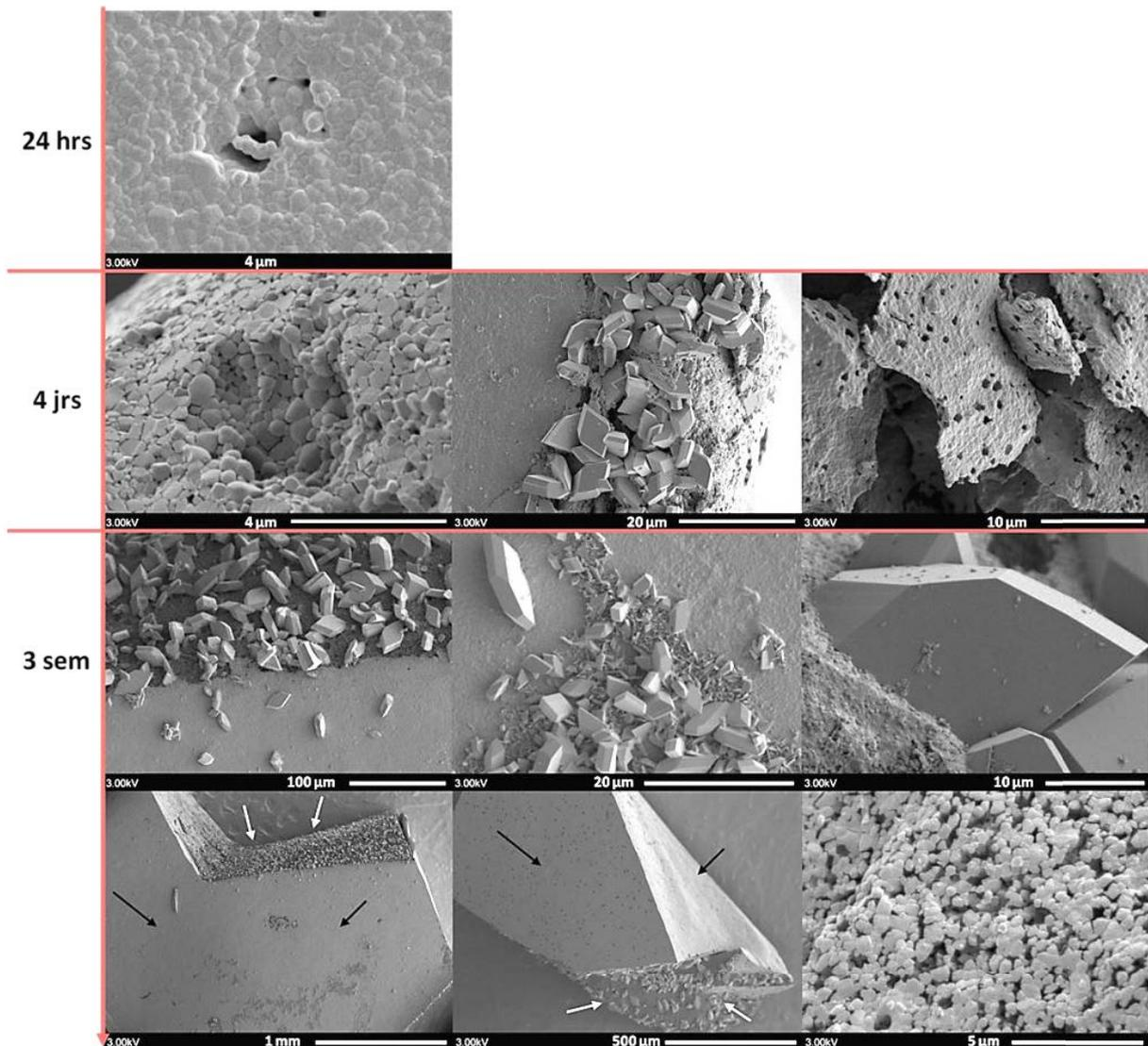
Figure 5-32 : Images MEB des pastilles d'HAp immergées dans une solution aqueuse d'oxalate de sodium ( $0,010 \text{ mol.L}^{-1}$ ) et de citrates ( $0,001 \text{ mol.L}^{-1}$ ) pendant : 24 heures, 4 jours et 3 semaines. Les flèches noires montrent la surface frittée de la pastille. Les flèches blanches montrent le cœur non fritté (le long de la cassure).
