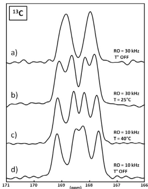
Figure 3-12 : Spectres  $^{13}\text{C}$  CP MAS de la phase COM et évolution en fonction de la température de l'échantillon et de la fréquence de rotation MAS. T° OFF : pas de régulation active de la température.  $d_1 = 2$  s et NS = 256 (512 pour le spectre c)).
