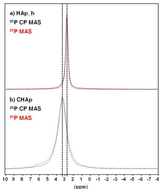
Figure 3-17 : a) spectres  $^{31}\text{P}$  MAS (rouge) et CP MAS (noir) de nanoparticules d'HAp obtenues par précipitation en voie aqueuse. RO = 14 kHz et b) spectres  $^{31}\text{P}$  MAS (rouge) et CP MAS (noir) de nanoparticules carbonatées (CHAp) obtenues par précipitation en voie aqueuse. HAp-h : phase hexagonale.
