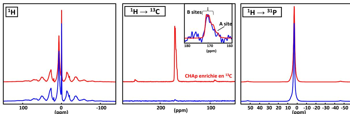
Figure 3-20 : Spectres DNP MAS et CP MAS, en abondance naturelle  $^{13}\text{C}$  (spectres bleus), et après enrichissement en  $^{13}\text{C}$  (spectres rouges) de CHAp, et en utilisant le mélange AMUpol/ $\text{D}_2\text{O}/\text{H}_2\text{O}$  (9/1). a)  $^1\text{H}$  DNP MAS. b)  $^{13}\text{C}$  DNP CP MAS. c)  $^{31}\text{P}$  DNP CP MAS. Tous les spectres présentés sont obtenus en présence d'irradiation microonde (ON). Les spectres  $^{13}\text{C}$  sont obtenus en 2 minutes environ.
