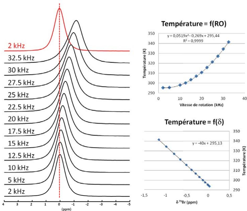
Figure 3-6 : Spectres  $^{79}\text{Br}$  de KBr (rotor plein) en fonction de la fréquence de rotation MAS (de 2 à 32,5 kHz) dans le cas d'une sonde Bruker 2,5 mm. Les courbes à droites montrent l'évolution de la température en fonction de la vitesse de rotation et en fonction de  $\delta^{79}\text{Br}$  (d'après l'équation de Thurber et coll. [28] appliquée aux  $\delta^{79}\text{Br}$  expérimentaux).
