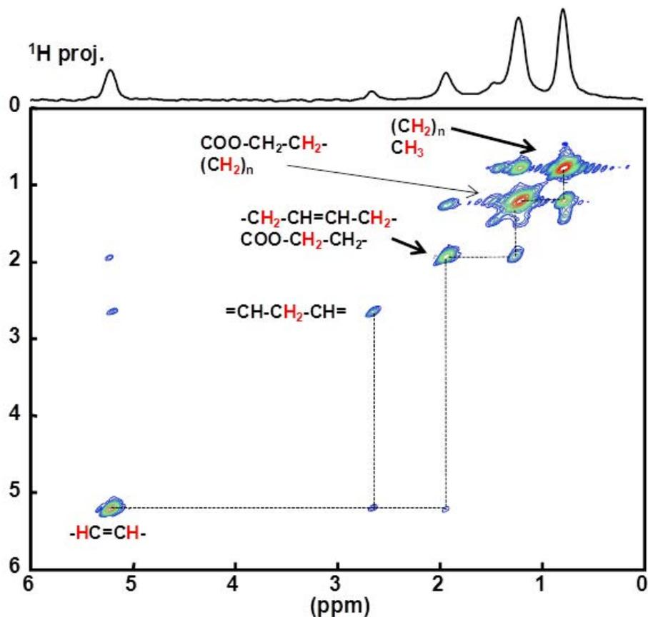
Figure 4-7 : Expérience  $^1\text{H}$ - $^1\text{H}$  DQF COSY MAS (30 kHz), 700 MHz, sonde MAS 2,5 mm. Délai de relaxation  $^1\text{H}$  : 2 s, NS = 32, incréments dans la dimension  $t_1$  : 256, représentation en mode magnitude.
