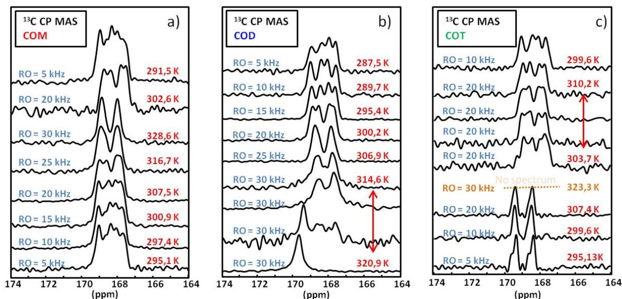
Figure 3-8 : Effets de l'augmentation de la fréquence de rotation MAS (de 5 kHz, spectre du bas, à 30 kHz puis retour à 5 kHz, spectre du haut). Sonde MAS de 2,5 mm. Aucune régulation en température n'est mise en œuvre. a) COM. b) COD (ici, le premier spectre à 30 kHz (en bas) correspond au point de départ de l'évolution du composé. c) COT.
