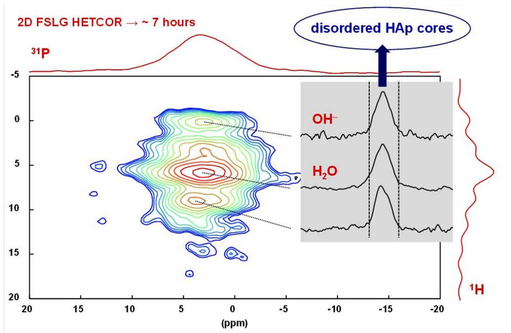
Figure 4-24 : Spectre 2D  $^1\text{H} \rightarrow ^{31}\text{P}$  DNP HETCOR CP MAS de la plaque Randall. Délai de relaxation : 12 s,  $\tau_{\text{CP}} = 7$  ms, NS = 16 et incréments  $t_1 = 128$ . Découplage FSLG durant l'évolution  $^1\text{H}$  en  $t_1$ .
