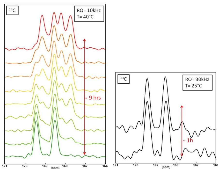
Figure 3-11 : Spectres  $^{13}\text{C}$  CP MAS de la phase COT et évolution en fonction de la température de l'échantillon et de la fréquence de rotation MAS. A droite : fréquence de rotation MAS : 30 kHz et température réglée à 25°C. A gauche : fréquence de rotation MAS : 10 kHz et température réglée à 40°C.  $d_1 = 2$  s et NS = 512.
