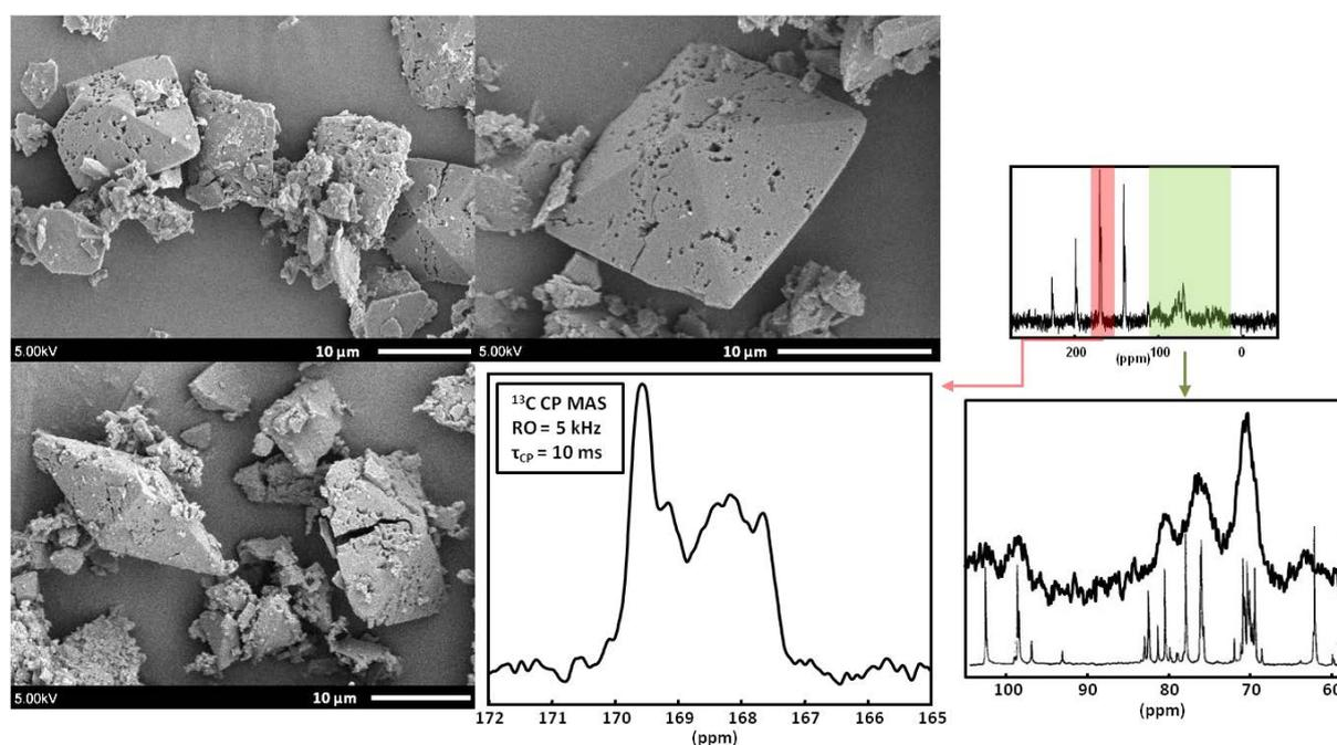
Figure 5-24 : Images MEB des cristaux issus de la synthèse en gel d'agar-agar (le gel contenant l'extrait de thé vert initialement) et spectre RMN  $^{13}\text{C}$  CP MAS. La présence d'agar-agar est mise en évidence en vert sur le spectre le spectre du bas correspond à l'agarose d'après [10].  $\tau_{\text{CP}}$  : temps de contact (ms); RO : fréquence de rotation MAS (kHz).
