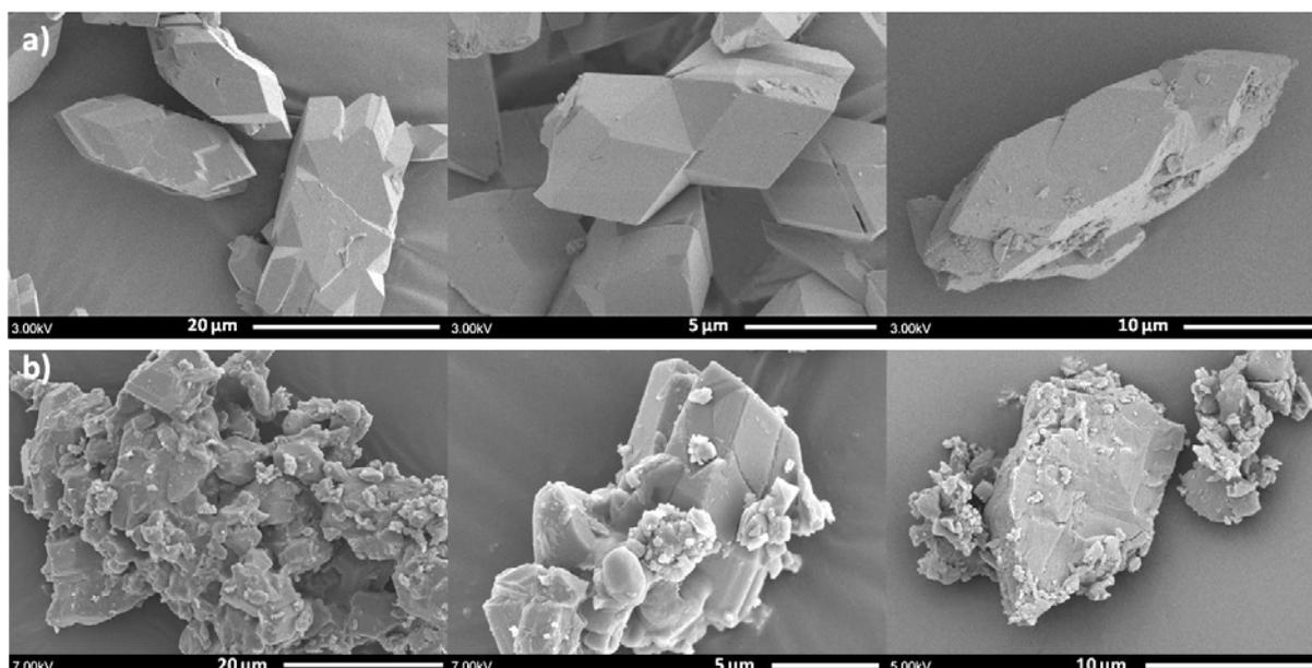
Figure 5-27 : Images MEB de a) cristaux de COM synthétisés par goutte à goutte en proportions stœchiométriques  $\text{Ca}/\text{Ox} = 1/1$  à  $T^\circ$  ambiante et laissés à vieillir 12 jours dans le milieu réactionnel (sans agitation). b) ces mêmes cristaux immergés dans 10 mL d'infusion de thé pendant 6 jrs.
