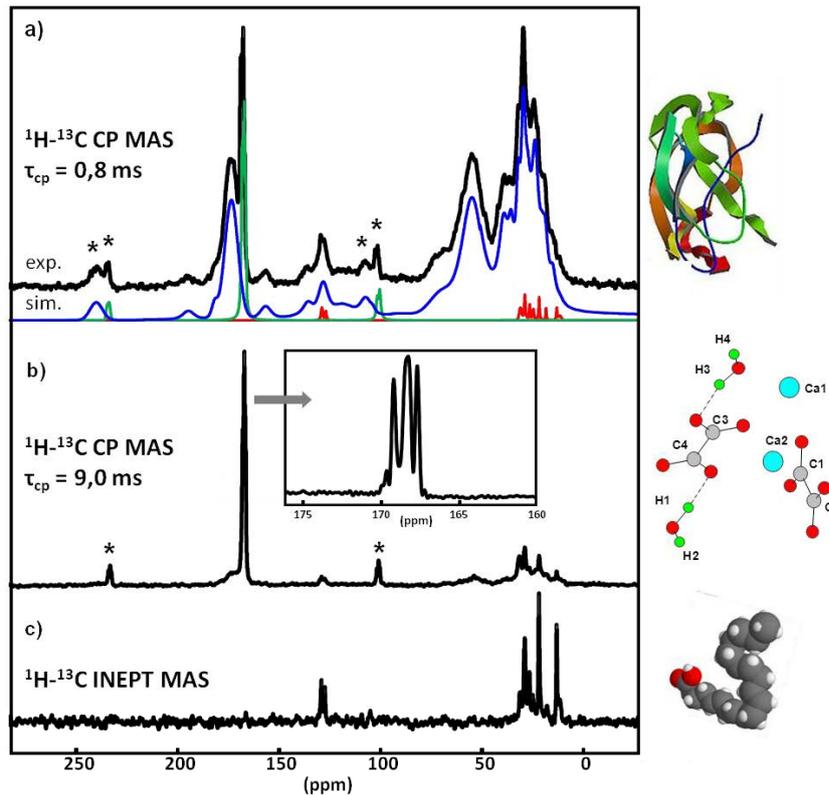
Figure 4-12 : Spectres  $^{13}\text{C}$  du calcul rénal KS 3 (celui-ci contient une forte proportion de matrice organique). a)  $^1\text{H} \rightarrow ^{13}\text{C}$  CP MAS avec un temps de contact court de 0,8 ms. b)  $^1\text{H} \rightarrow ^{13}\text{C}$  CP MAS avec un temps de contact long de 9,0 ms. c)  $^1\text{H} \rightarrow ^{13}\text{C}$  INEPT MAS. Illustrations : protéines, oxalate de calcium monohydraté (COM) et acides gras.
