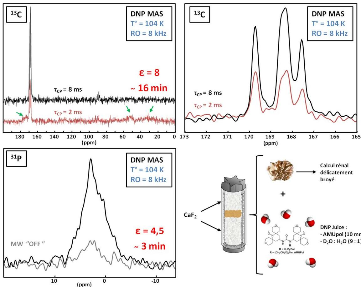
Figure 4-25 : Spectres  $^1\text{H} \rightarrow ^{13}\text{C}$  et  $^1\text{H} \rightarrow ^{31}\text{P}$  DNP CP MAS du calcul rénal associé à la plaque de Randall présentée sur la Figure 4-21. AMUpol/ $\text{D}_2\text{O}/\text{H}_2\text{O}$  (9/1). Les expériences  $^1\text{H} \rightarrow ^{13}\text{C}$  DNP CP MAS ont été réalisées à deux temps de contacts différents :  $\tau_{\text{CP}} = 8$  ms (en noir) et  $\tau_{\text{CP}} = 2$  ms (en rouge).
