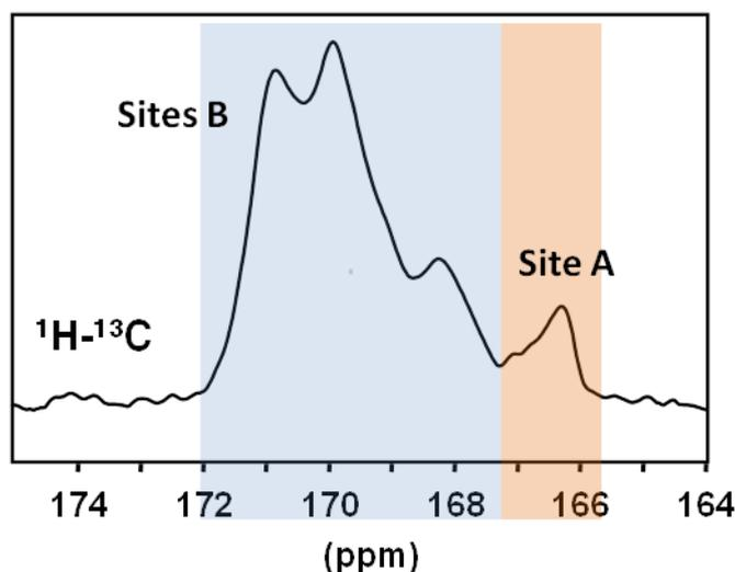
Figure 3-18 : Spectre  $^{13}\text{C}$  CP MAS de CHAp (sonde 3,2 mm, 700 MHz) (ce spectre correspond à la projection d'une expérience  $^1\text{H} \rightarrow ^{13}\text{C}$  HETCOR CP MAS). Sites A et B d'après [40].
