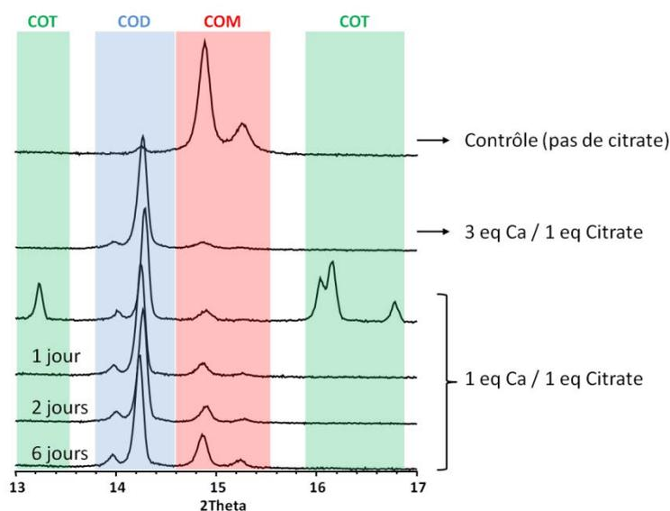
**Figure 5-9 : Diffractogrammes des échantillons synthétisés en présence d'ions citrates. Le diffractogramme correspondant à la synthèse de contrôle (absence de citrates) est présenté en haut de la figure. Les zones rouge, bleue et verte correspondent aux pics de diffraction caractéristiques du COM, COD et COT, respectivement.  $[\text{Ca}^{2+}]/[\text{citrate}] = 3,0$  et 1,0.**
