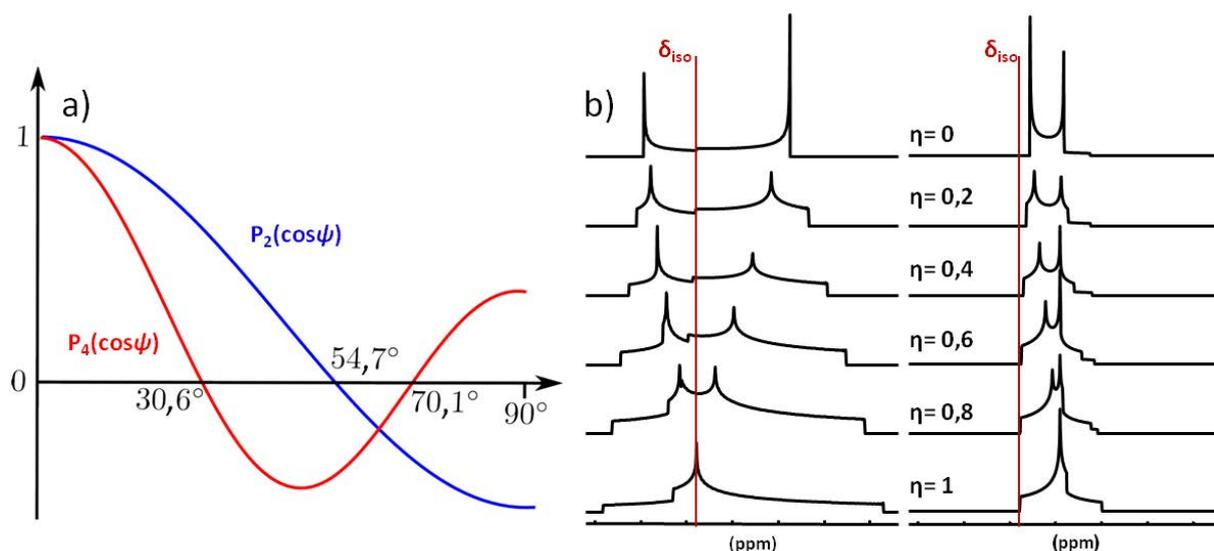
Figure 2-17 : a) Représentation des polynômes de Legendre  $P_2(\cos \psi)$  et  $P_4(\cos \psi)$  en fonction de l'angle d'inclinaison  $\psi$  du rotor par rapport au champ  $B_0$ . b) Formes de raie théoriques de la transition centrale en mode statique (à gauche) et en MAS à fréquence infinie (à droite) pour différentes valeurs de  $\eta_Q$ , CT d'un spin  $I = 7/2$ .
