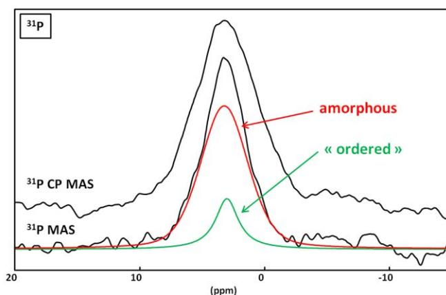
Figure 4-18 : Spectres  $^{31}\text{P}$  MAS ; délai de relaxation : 60 s et  $^1\text{H} \rightarrow ^{31}\text{P}$  CP MAS délai de relaxation : 3 s et  $\tau_{\text{CP}} = 2$  ms de la plaque de Randall, RO = 14 kHz. Une déconvolution permet d'estimer la partie amorphe et la partie cristalline.
