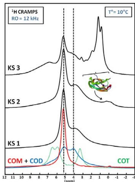
Figure 4-4 : Spectres  $^1\text{H}$  CRAMPS de trois calculs rénaux (KS 1, KS 2 et KS 3). Les spectres  $^1\text{H}$  CRAMPS du COM (en rouge), du COD (en bleu) et du COT (en vert) synthétiques sont rappelés. Le schéma de protéine indique la présence de résonances dues à la matrice organique dans les calculs KS 2 et KS 3. Sonde MAS 2,5 mm, 700 MHz.
