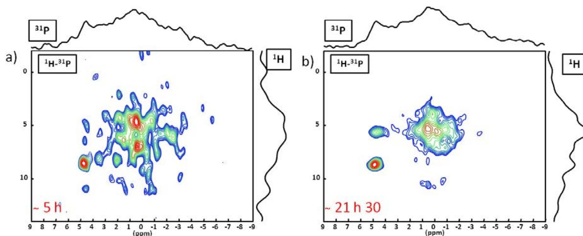
Figure 4-15 : Spectres 2D  $^1\text{H} \rightarrow ^{31}\text{P}$  HETCOR CP MAS du calcul rénal KS 4 à différents  $\tau_{\text{CP}}$ . a)  $\tau_{\text{CP}} = 0,5$  ms ;  $d1 = 3$  s ;  $\text{RO} = 12,5$  kHz et  $T^\circ$  ambiante. b)  $\tau_{\text{CP}} = 5,0$  ms ;  $d1 = 3$  s ;  $\text{RO} = 30$  kHz et  $T = 253$  K.
