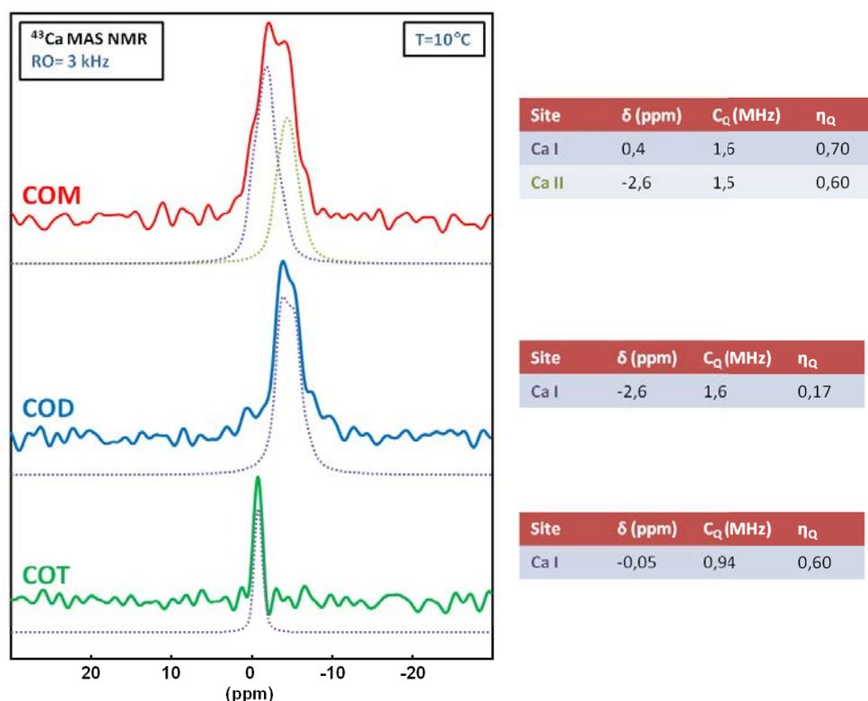
Figure 3-4 : Spectres RMN  $^{43}\text{Ca}$  MAS des phases synthétiques de COM, COD et COT (spectromètre 850 MHz, sonde 7 mm MAS). DFS avant l'impulsion. Délai de relaxation : 0,8 s. Temps expérimental : COM 1 h 40, COD 4 hrs et COT 1 h 15. Tableaux : paramètres RMN extraits des spectres MAS (à plusieurs champs magnétiques).  $\delta_{\text{iso}}(^{43}\text{Ca}) = \pm 1,0 \text{ ppm}$ ,  $C_Q(^{43}\text{Ca}) = \pm 0,20 \text{ MHz}$ ,  $\eta_Q(^{43}\text{Ca}) = \pm 0,3$  [24].
