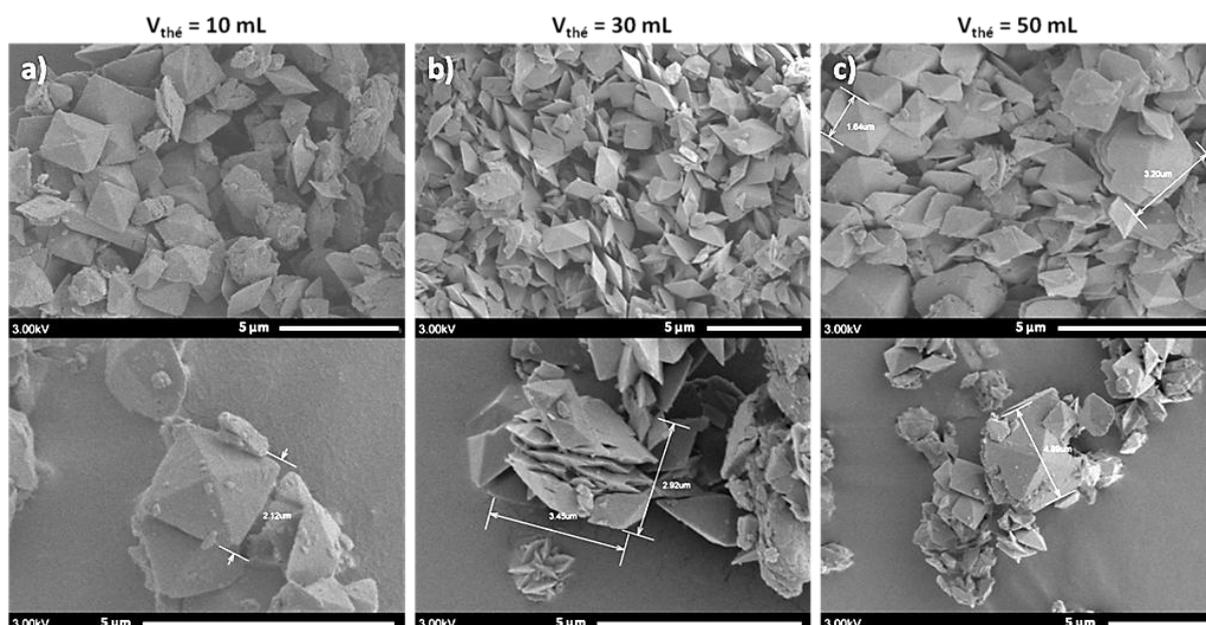
Figure 5-22 : Images MEB des synthèses par goutte à goutte avec ajout de thé ( $V_{\text{thé}}$  variable) à température ambiante. a)  $V_{\text{thé}} = 10$  mL. b)  $V_{\text{thé}} = 30$  mL. c)  $V_{\text{thé}} = 50$  mL. La définition de  $V_{\text{thé}}$  est donnée dans le paragraphe 1.c).ii.
