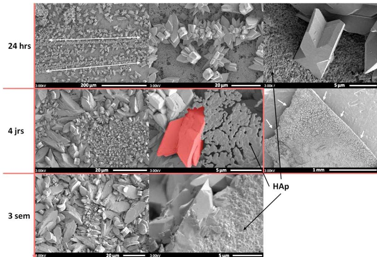
Figure 5-31 : Images MEB des pastilles d'HAp immergées dans une solution aqueuse d'oxalate de sodium ( $0,010 \text{ mol.L}^{-1}$ ,  $\text{pH} = 3,7$ ) pendant : 24 heures, 4 jours et 3 semaines. En rouge un cristal de COM. Les flèches blanches indiquent le bord de la pastille d'HAp.
