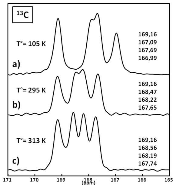
Figure 3-15 : a) spectre  $^{13}\text{C}$  CP DNP MAS (400 MHz) de la phase COM (fréquence de rotation : 8 kHz)  $T^\circ= 105$  K. b) spectre  $^{13}\text{C}$  CP MAS (700 MHz) de la phase COM (fréquence de rotation : 10 kHz)  $T^\circ= 295$  K et c) spectre  $^{13}\text{C}$  CP MAS (700 MHz) de la phase COM (fréquence de rotation : 10 kHz)  $T^\circ= 313$  K.
