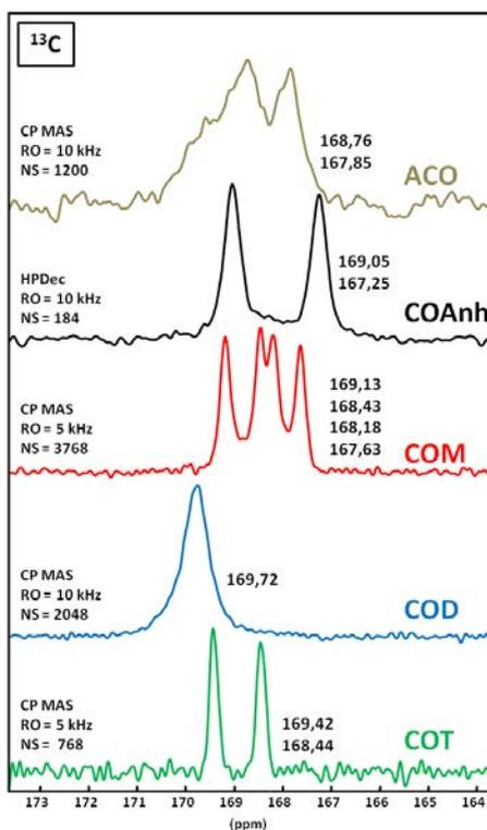
Figure 3-2 : Spectres RMN  $^{13}\text{C}$  CP MAS des trois phases hydratées d'oxalates de calcium (COM, COD et COT) et de l'oxalate de calcium amorphe (ACO). Le spectre  $^{13}\text{C}$  HPDEC  $\{^1\text{H}\}$  de la phase d'oxalate de calcium anhydre (COAnh) est également présenté. RO : fréquence de rotation MAS (kHz). NS le nombre de scans. d1 (délai de relaxation  $^1\text{H}$ ) = 3 s. (d1 = 120 s pour COAnh).
