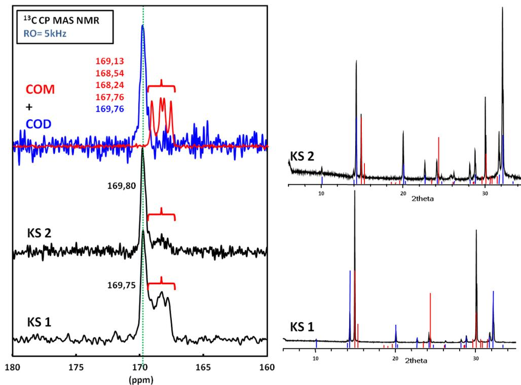
Figure 4-8 : Spectres  $^1\text{H} \rightarrow ^{13}\text{C}$  CP MAS des deux calculs rénaux, KS 1 et KS 2 avec leur diffractogramme respectif. Les spectres du COM (en rouge) et du COD (en bleu) synthétiques sont rappelés également. Sonde MAS 2,5 mm, 700 MHz.
