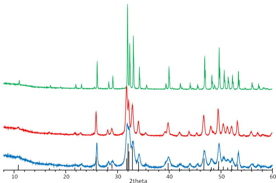
Figure 1-25 : Diffractogrammes d'Hap traitées à différentes températures, à  $100^\circ\text{C}$  (en bleu), à  $450^\circ\text{C}$  (en rouge) et à  $1100^\circ\text{C}$  (en vert). En noir, la fiche JCPDS 9-432 (hexagonale).
