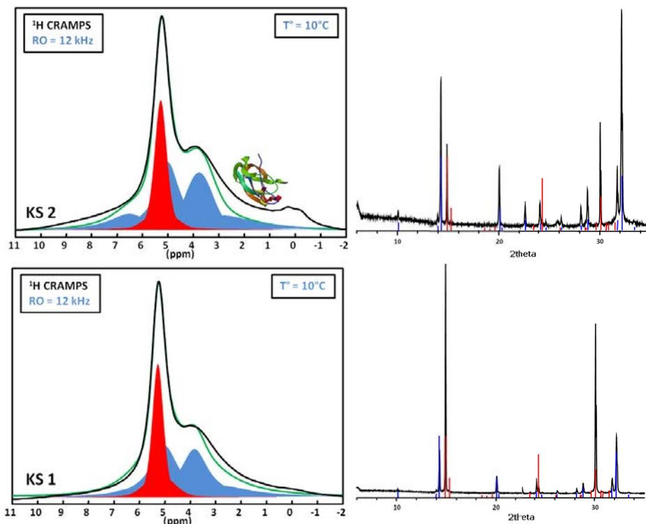
Figure 4-5 : Simulation des spectres  $^1\text{H}$  CRAMPS de KS 1 et KS 2. En rouge : COM. En bleu : COD. En vert : somme. Les diffractogrammes sont rappelés pour comparaison. Sonde MAS 2,5 mm, 700 MHz.
