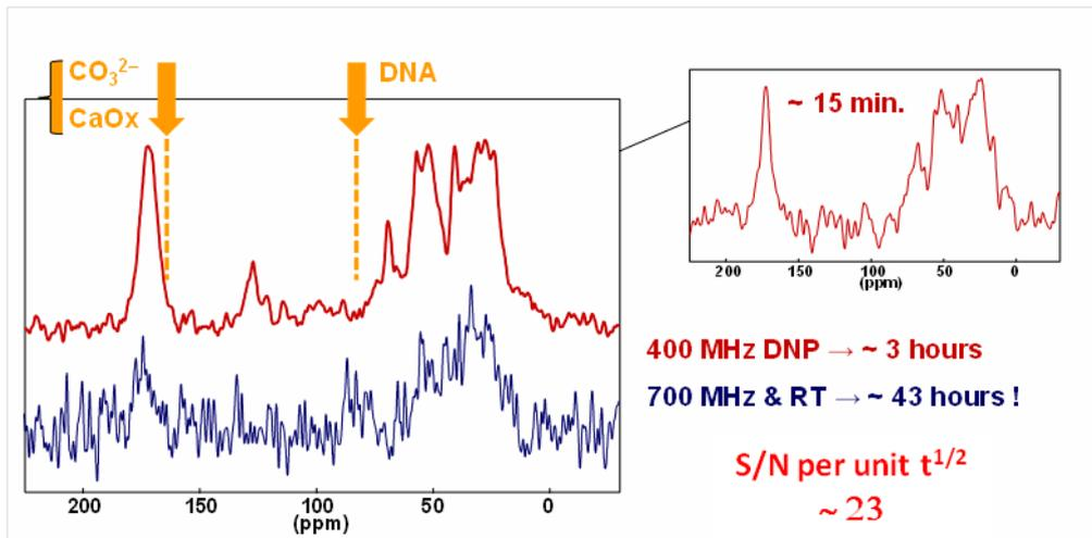
Figure 4-22 : Spectre DNP  $^1\text{H} \rightarrow ^{13}\text{C}$  CP MAS de KS 3 comparé au spectre  $^1\text{H} \rightarrow ^{13}\text{C}$  CP MAS classique de KS 3 obtenu par RMN standard (température ambiante, 700 MHz).
