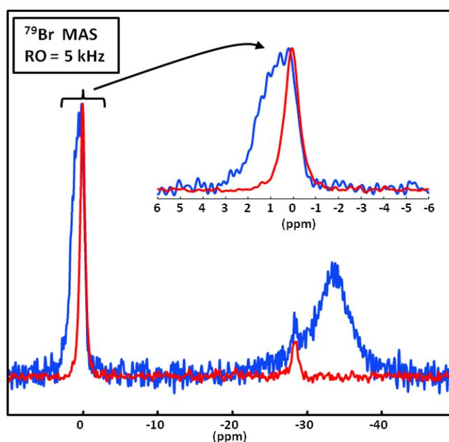
Figure 3-7 : Spectres  $^{79}\text{Br}$  (en rouge) d'un mélange KBr + COD (rotor plein) pour une fréquence MAS de 5 kHz. Après une période d'environ 16 heures, le spectre  $^{79}\text{Br}$  se modifie notablement due à l'hydratation partielle de KBr et la transformation spontanée de COD en COM (en bleu).
