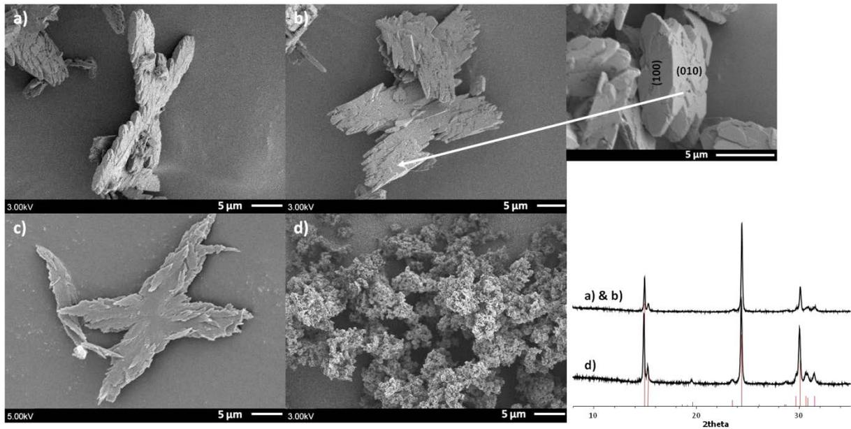
Figure 1-18 : Images MEB de COM et DRX a) b) c) Synthèse équimolaire *sans agitation*, à  $T_{amb}$  et  $[Ca_2^+] = 0,010$  M avec vieillissement de 1 mois d) Synthèse équimolaire, à  $T < 4^\circ C$  et  $[Ca_2^+] = 0,100$  M.
