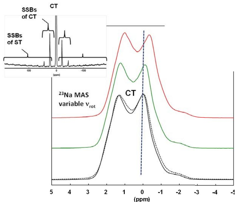
Figure 3-13 : Spectres  $^{23}\text{Na}$  MAS (transition centrale) de la phase  $\text{NaHC}_2\text{O}_4\cdot\text{H}_2\text{O}$  (spectromètre 850 MHz, sonde MAS 3,2 mm HX). La fréquence de rotation MAS est variable : 5 kHz (en noir, trait continu), 10 kHz (en vert), 20 kHz (en rouge), retour à 5 kHz (en noir, trait pointillé). Insert en haut à gauche : spectre MAS complet mettant en évidence la transition centrale (CT) et les transitions satellites (ST).
