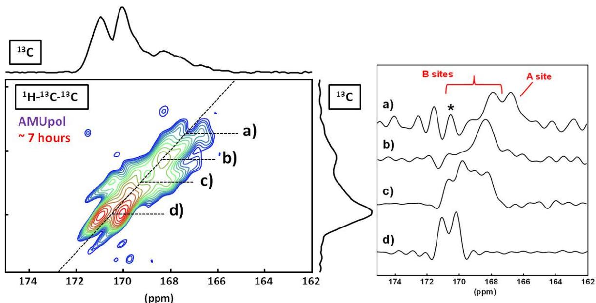
Figure 3-23 : En haut : spectre 2D DNP SPC5 MAS (recouplage dipolaire homonucléaire) de CHAp, enrichie en  $^{13}\text{C}$  :  $^1\text{H} \rightarrow ^{13}\text{C} \rightarrow ^{13}\text{C}$ . AMUpol/D<sub>2</sub>O/H<sub>2</sub>O (90/10). En bas : tranches  $^{13}\text{C}$  extraites aux déplacements chimiques a), b), c) et d). Traitement du signal de type GB sur la voie indirecte. \* ne pas tenir compte de ce signal, qui correspond à une oscillation induite par le traitement GB.
