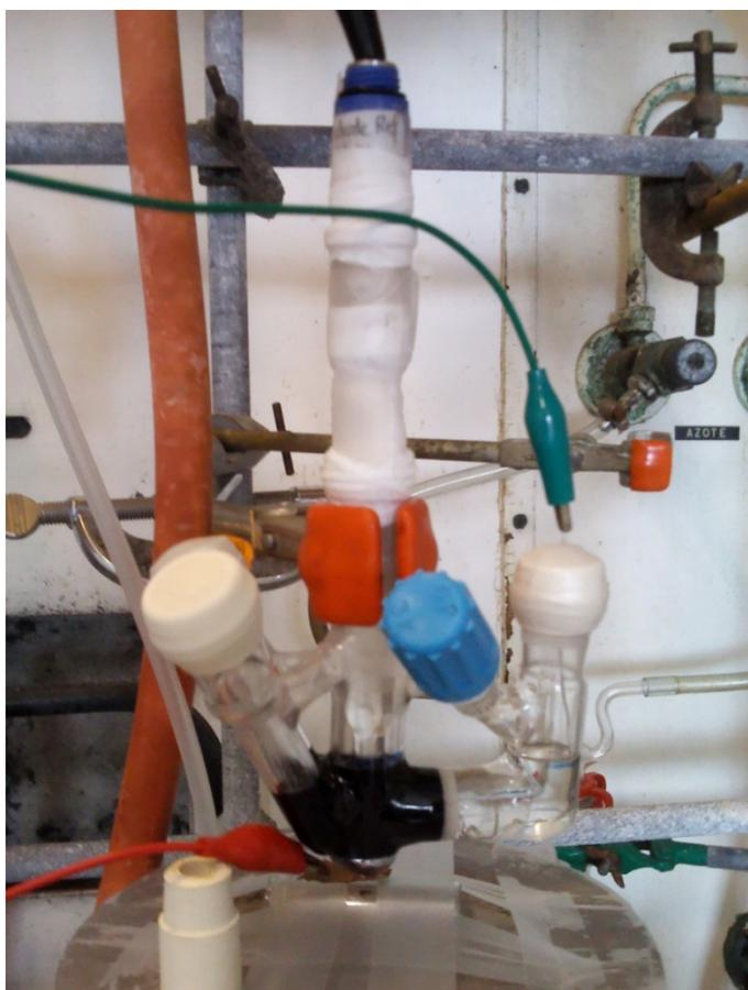
Figure 101 Cellule à deux compartiments en cours d'électrolyse
