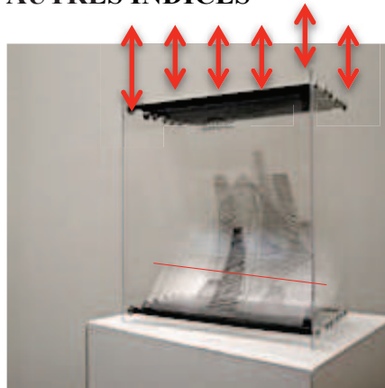
Modèle optique/Architecture sonore 6 plans amovibles (mêmes niveaux de HP par plan, ligne rouge = gradins)
