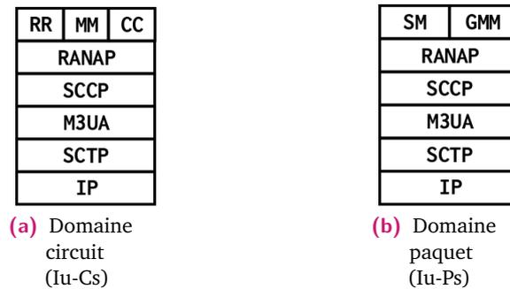
**Figure 1.3** : Couches protocolaires sur les interfaces Iu.
