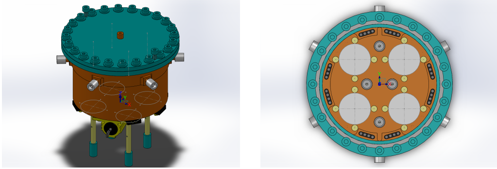
Figure 6.1 – Vue isométrique et vue de dessus de la cellule à 4 échantillons réalisées pour nos expériences. La disposition des échantillons est très similaire à celle de la cellule à 2 échantillons, décrite en détail Figure 5.4. Les vues présentées ici permettent de mieux se rendre compte de la disposition globale de la cellule, et en particulier du cheminement électrique.
