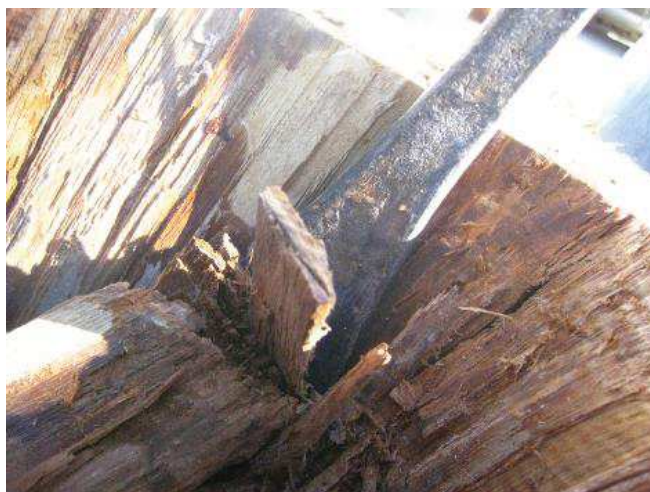
Figure 35 – Travail à la gouge, dans un tronc de châtaignier sec (Photo : A. Lehébel-Péron)
