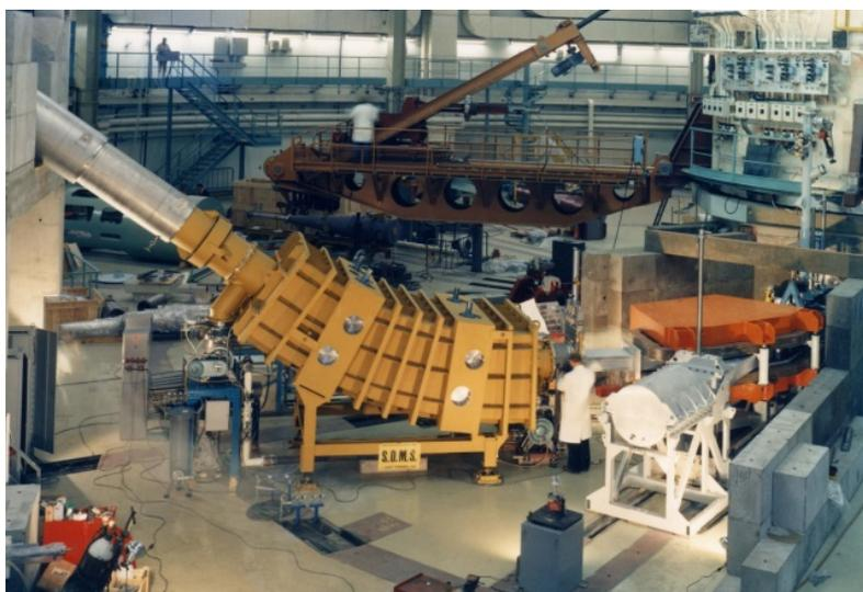
FIGURE 2.3: Le spectromètre de masse Lohengrin [59].
